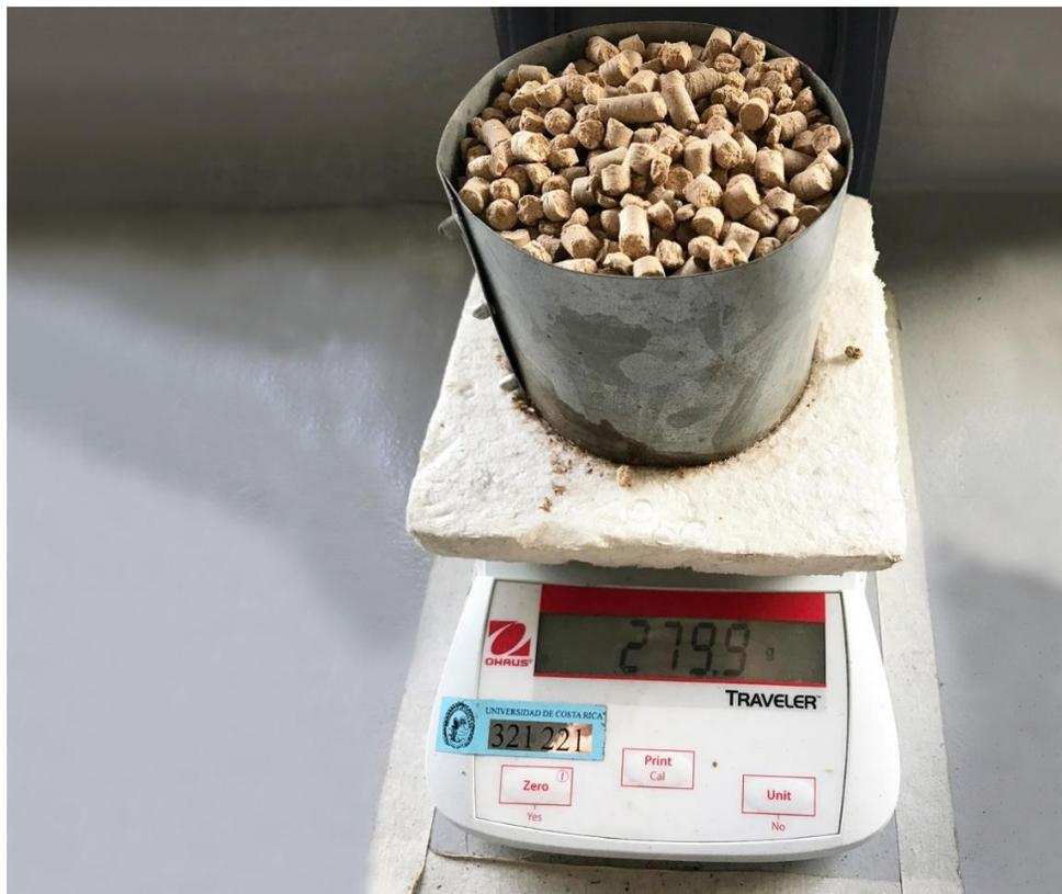
**Figura 2.6.** Determinación de la densidad aparente.
