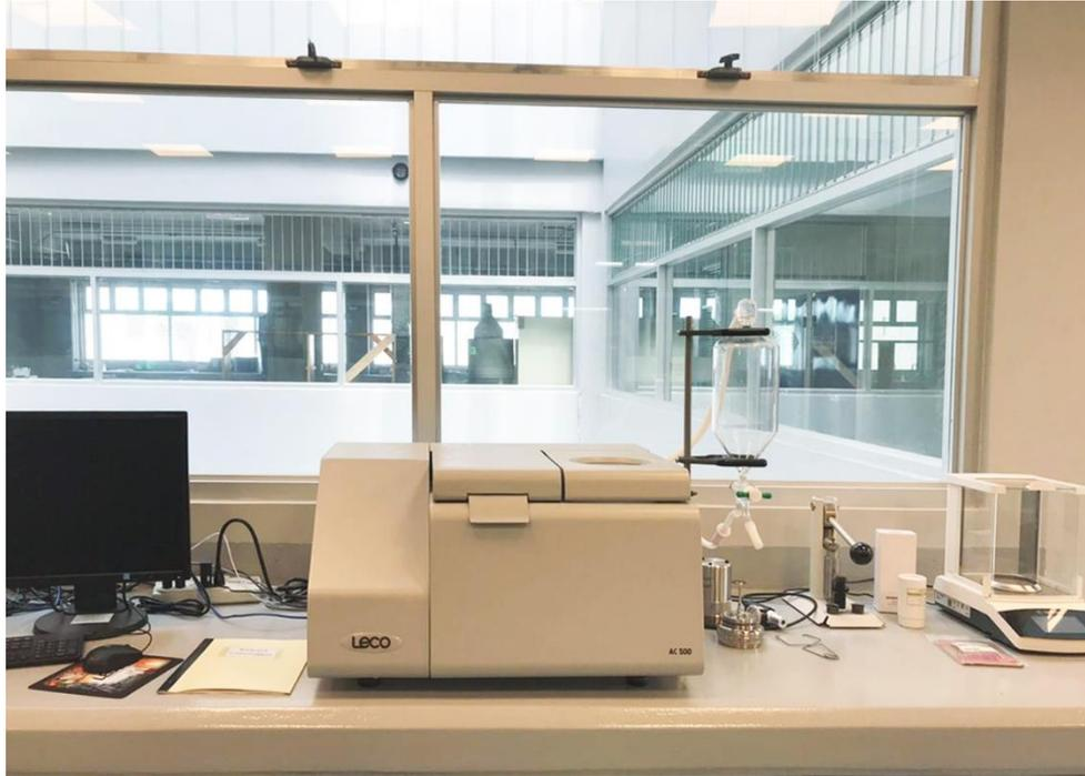
**Figura 2.10.** Bomba calorimétrica marca Leco AC500.
