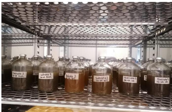
**Figura 10.** Biorreactores en condiciones contraladas dentro de incubadora.
