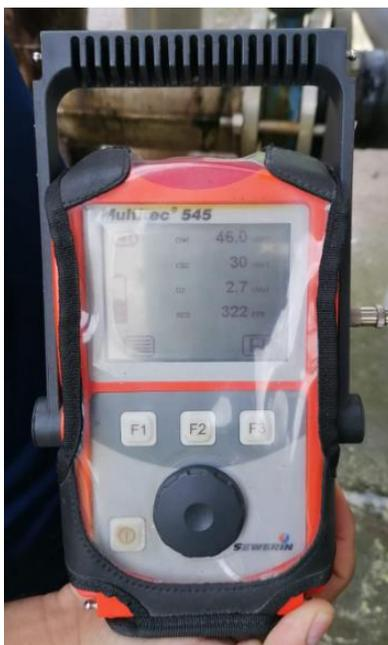
**Figura 11.** Medidor de gases Multitec 545.
