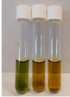
**Figura 8.** Tubos de ensayo para pruebas de DQO después de salir del horno.
