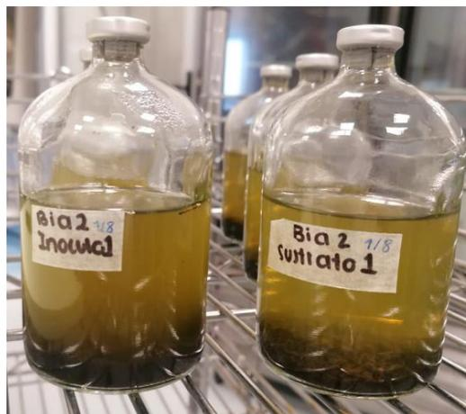
**Figura 9.** Biorreactor tipo batch utilizado en el laboratorio.
