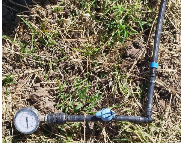
Figura 7. Medición de la presión en un lateral de riego por medio de un manómetro para la determinación del CU_p en la Ciudad de la Niños, Cartago.
