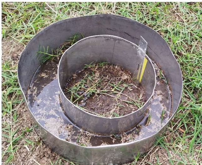
Figura 3. Colocación de los anillos para la prueba de infiltración en el suelo en campo abierto de la Ciudad de los Niños.
