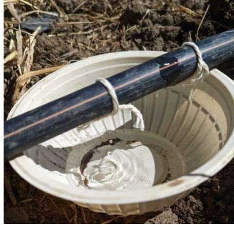
Figura 6. Recolección de agua de riego emitida por un gotero para la determinación del CU en la Ciudad de la Niños, Cartago.
