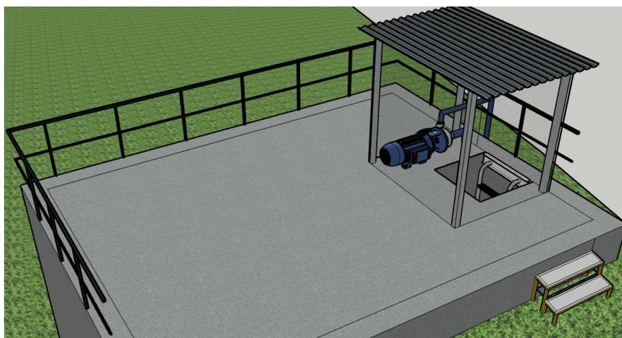
**Figura 32.** Vista isométrica superior del tanque de desfogue de la PTAR Los Tajos con intervención para ingreso de la tubería para redireccionamiento de caudal al sistema de tratamiento propuesto. Elaboración propia en Sketchup.
