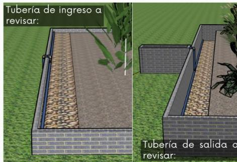
Tanto la tubería de ingreso y salida de caudal de salida se encuentran en la sección de 0,75 m de ancho que posee piedra bola.
