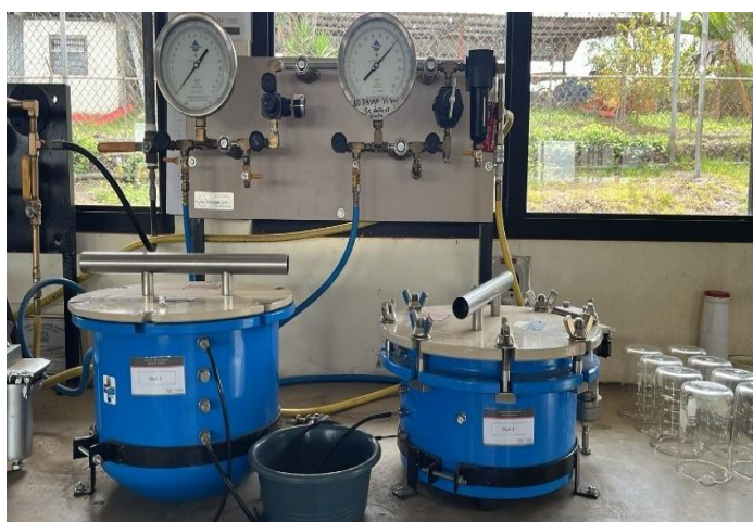
Figura 2. Ollas de succión a 15000 hPa para la determinación de punto de marchitez permanente.
