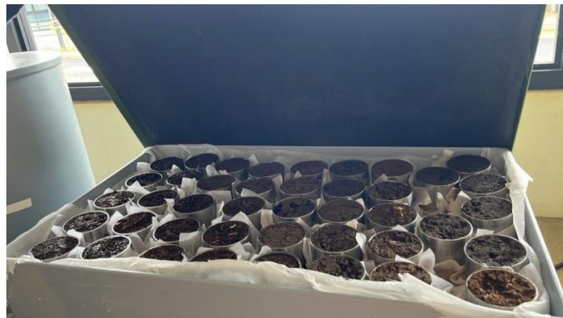
Figura 4. Cilindros con muestras de suelo previamente pesadas con malla y con liga para medición de capacidad de campo a 330 hPa.
