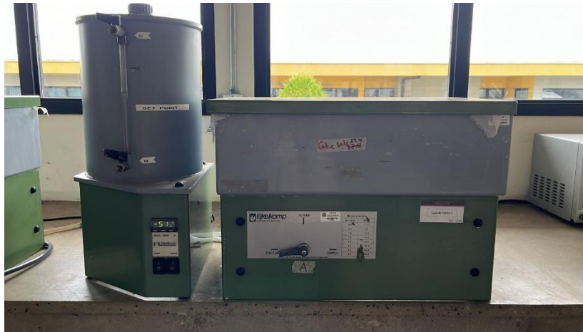
Figura 3. Equipo de caja de arena para la estimación de capacidad de campo a 330 hPa.
