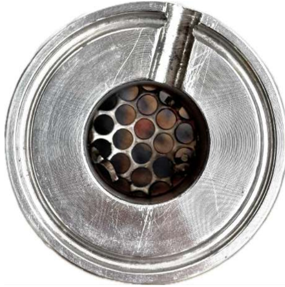
Figura 13. Plenum a la entrada de la cámara de tostado.
