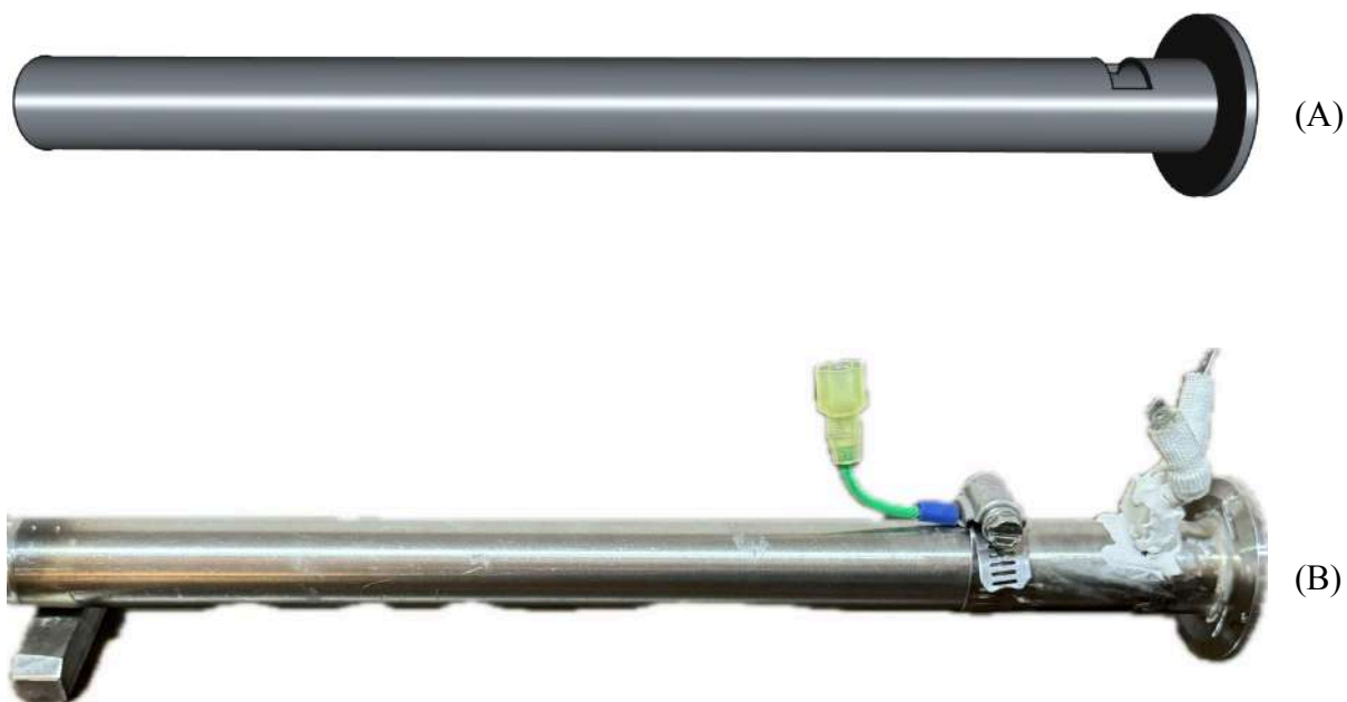
Figura 17. Modelo en CAD (A) y fotografía (B) de la sección para la resistencia eléctrica.
