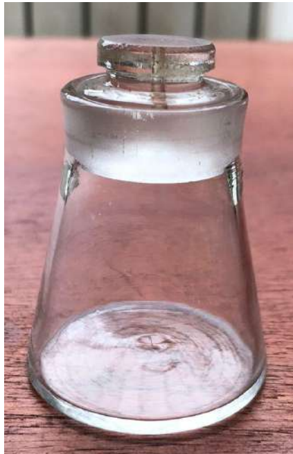
Figura 4. Picnómetro (elaboración propia).
