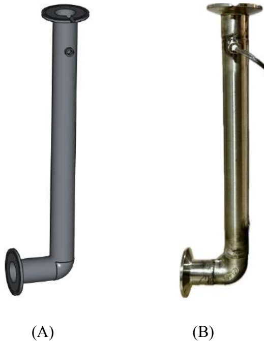
Figura 18. Modelo en CAD (A) y fotografía (B) de la sección donde se ubican el sensor de temperatura y el tubo Pitot.
