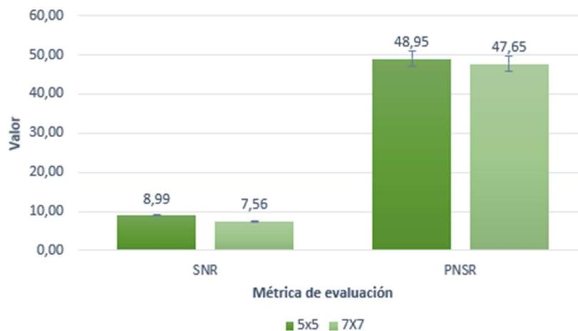
**Figura 8.** Promedio de los valores de SNR y PNSR obtenidos para los tamaños de ventana 5x5 y 7x7 del filtro Gamma Map.
