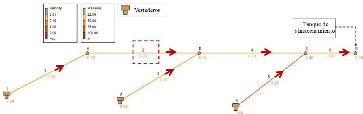
**Figura 42.** Modelo hidráulico obtenido en Epanet para la tubería de distribución de vertedero a tanque de almacenamiento.
