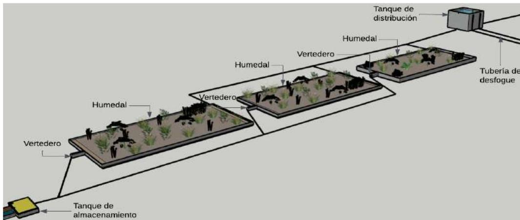
**Figura 51.** Diseño 3D del tren de tratamiento propuesto. Elaboración propia con Sketchup.
