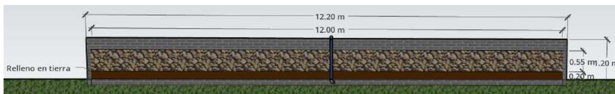
**Figura 44.** Vista frontal de la primera unidad de humedal artificial. Elaboración propia con Sketchup
