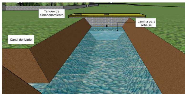
**Figura 57.** Vista de canal principal con derivación y lámina para rebalse. Elaboración propia con Sketchup.
