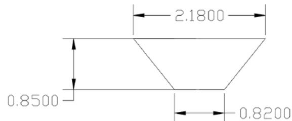
**Figura 54.** Dimensiones del perfil del canal trapezoidal nuevo propuesto. Unidades en m.
