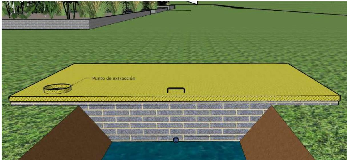
**Figura 49.** Diseño de tanque de almacenamiento propuesto con tapa y punto de succión.
