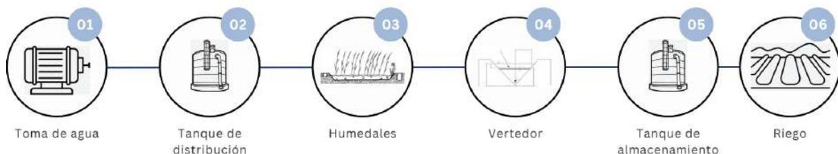
**Figura 25.** *Flujo del sistema propuesto para el sistema de tratamiento*
