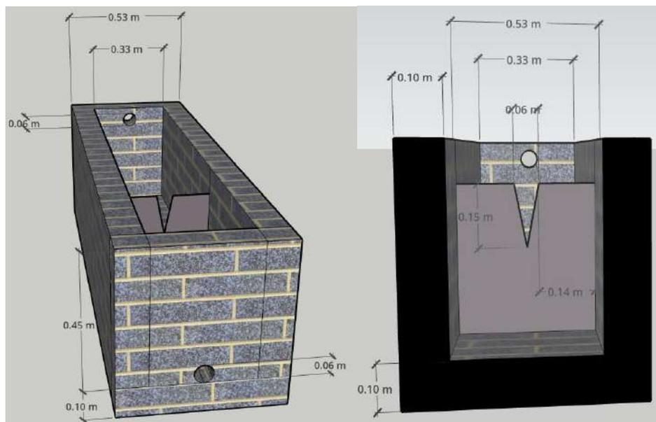
**Figura 41.** Diseño de vertedero propuesto. Elaboración propia con Sketchup.
