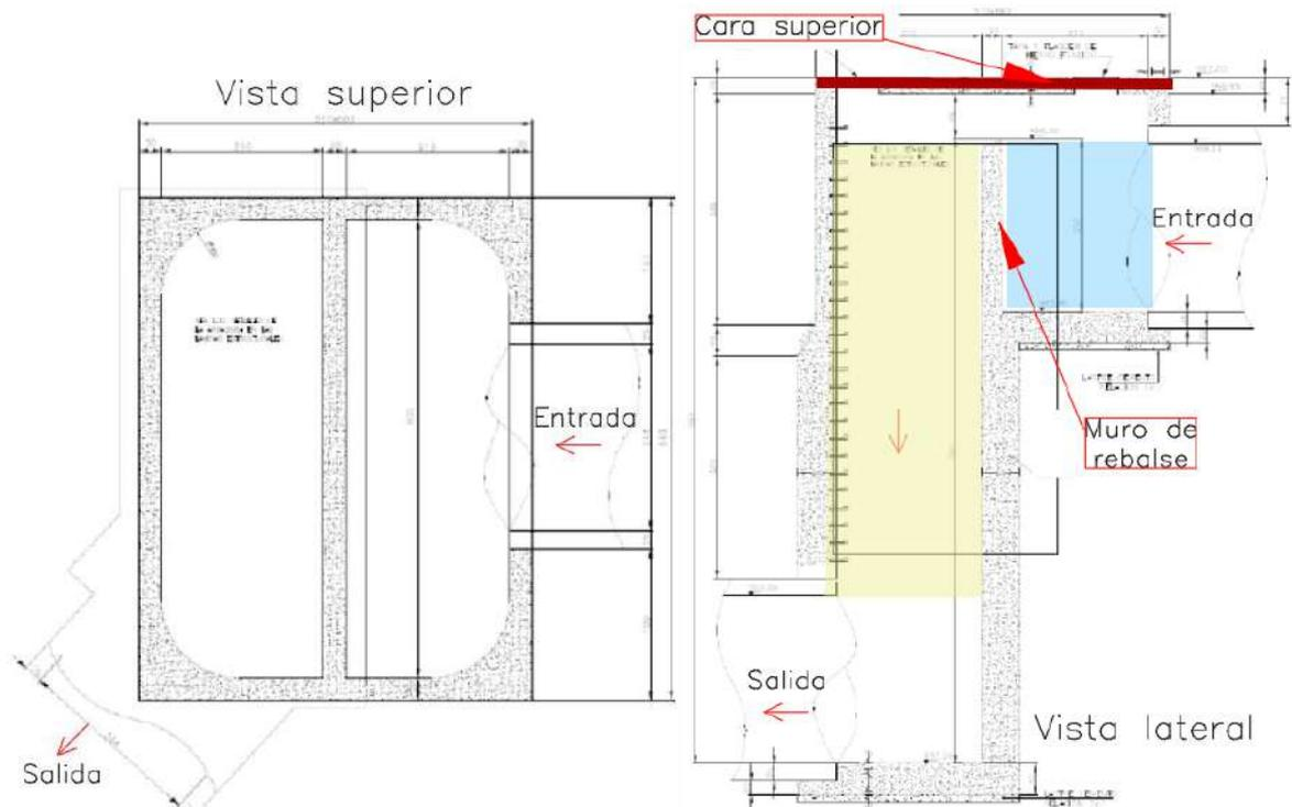
**Figura 31.** Vista superior y corte lateral del pozo de desfogue de la PTAR Los Tajos, con señalización de la cara superior y lateral al nivel de piso. Fuente: Planos técnicos proporcionados por AyA.
