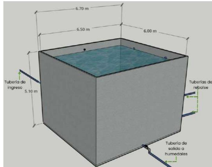
**Figura 35.** Vista lateral e isométrica del tanque de distribución. Elaboración propia con Sketchup
