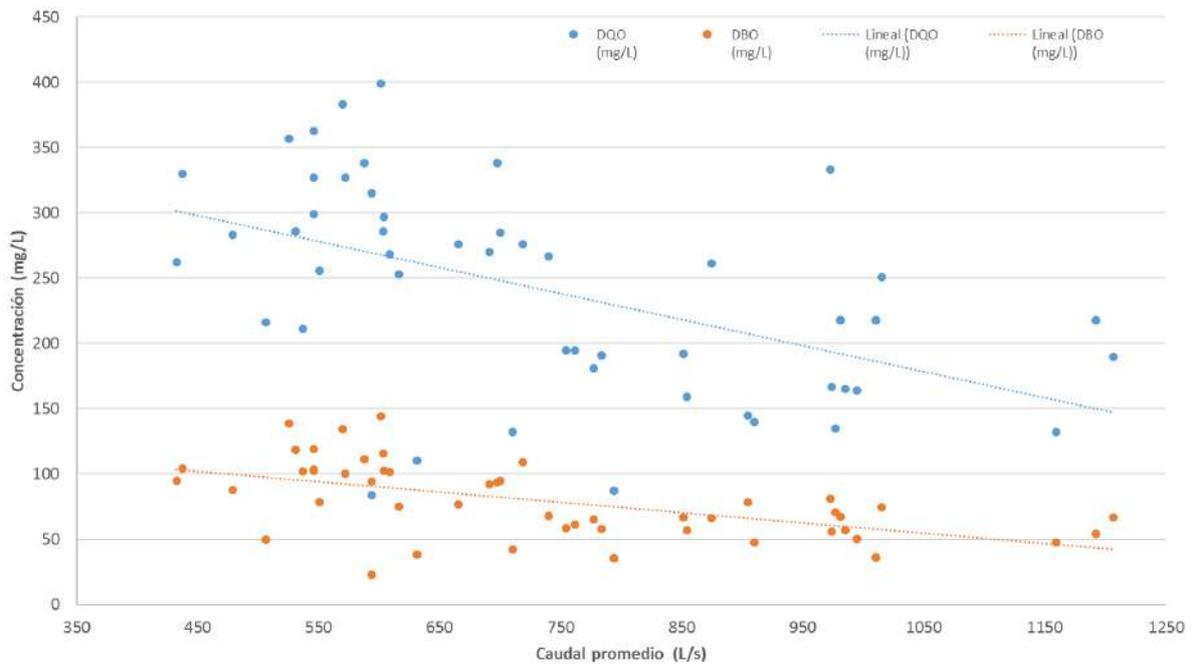
**Figura 18.** Dispersión de las concentraciones de DBO y DQO registrados en la PTAR Los Tajos en el 2023.
