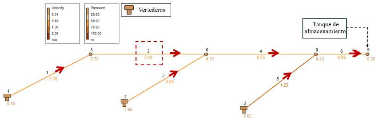
**Figura 43.** Modelo hidráulico obtenido en Epanet para la tubería de distribución de vertedero a tanque de almacenamiento, con variación de altura.
