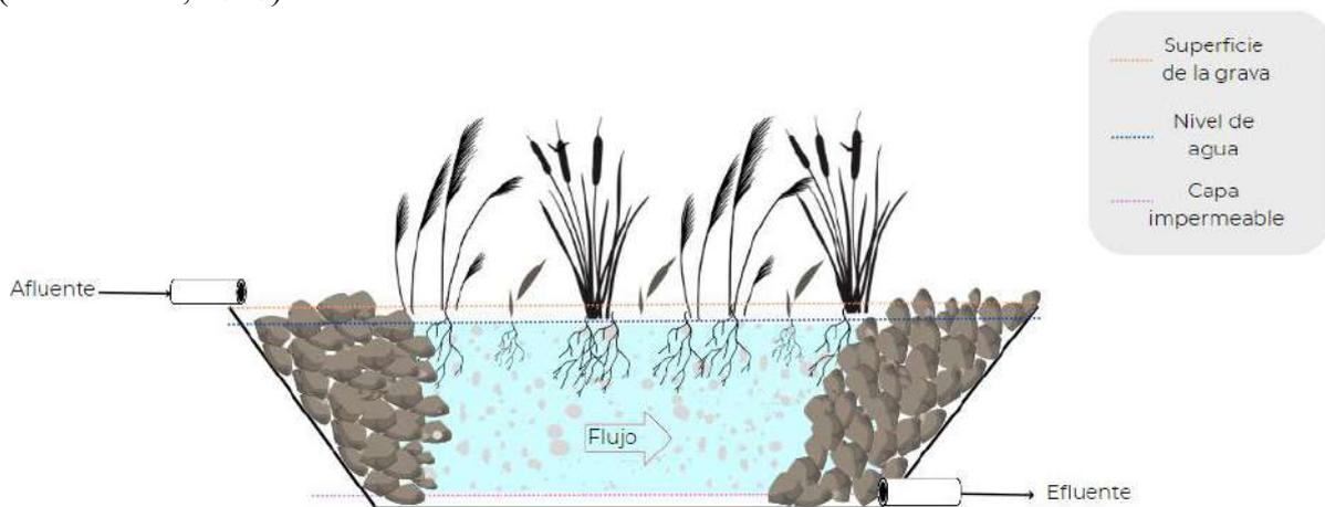
**Figura 1.** Esquema de funcionamiento de humedal artificial de flujo subsuperficial horizontal. Modificado de Dotro et al (2017).
