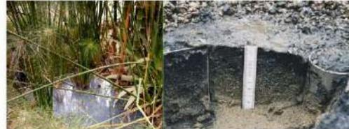
Un lecho filtrante en buenas condiciones debe apreciarse sin encharcamientos y sin rutas preferenciales, como se muestra en la siguiente figura:
