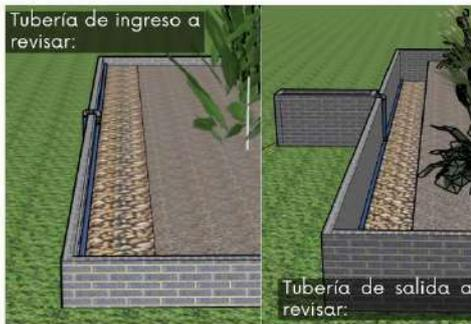
Tanto la tubería de ingreso y salida de caudal de salida se encuentran en la sección de 0,75 m de ancho que posee piedra bola.
