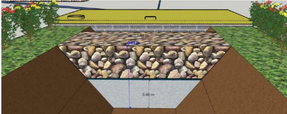
**Figura 56.** Corte del canal principal de riego. Elaboración propia con Sketchup.
