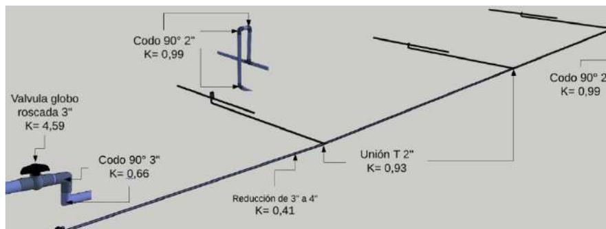
**Figura 37.** Isométrico de tubería de distribución de tanque a humedales, con accesorios y sus coeficientes de pérdidas. Elaboración propia con Sketchup
