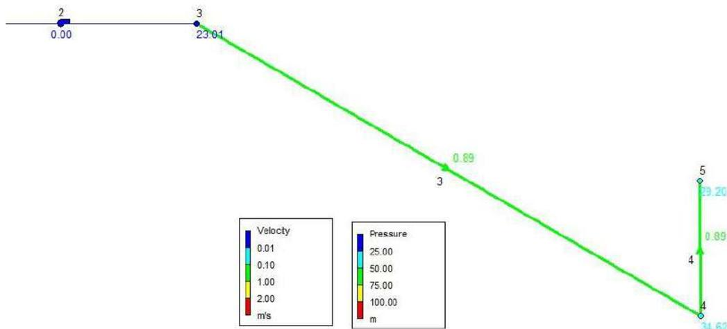
**Figura 34.** Simulación de sistema de tubería de envío de caudal con bomba centrífuga.
