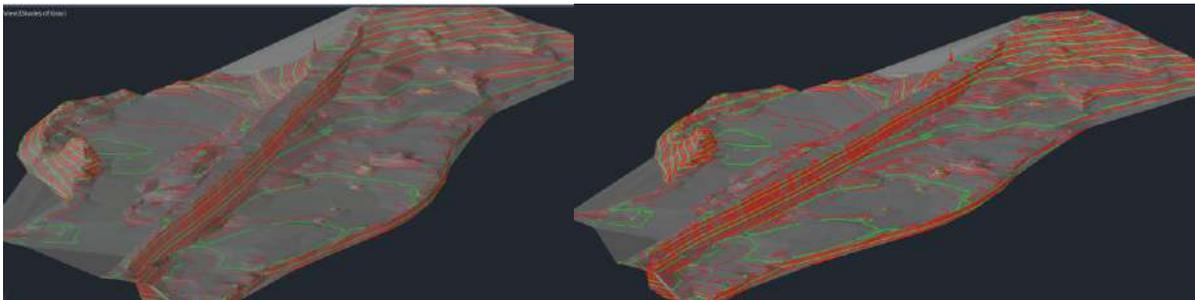
**Figura 24.** Finca de la PTAR en 3D. Superficie 3D creada en Civil 3D con archivo de curvas de nivel facilitado por el AyA.
