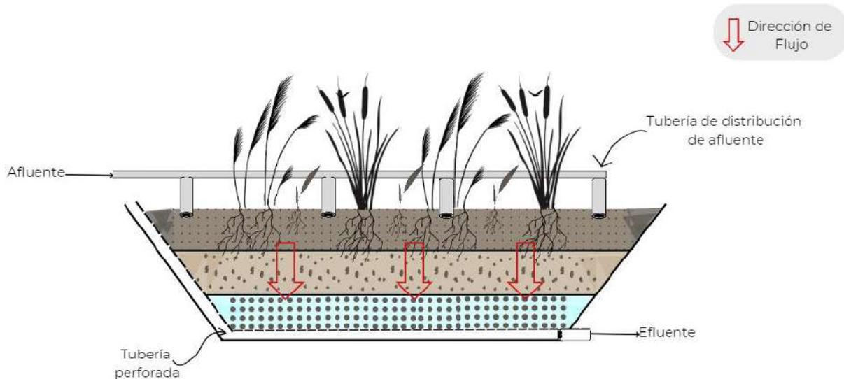
**Figura 2.** Esquema de funcionamiento de humedal artificial de flujo subsuperficial vertical. Modificado de Dotro et al (2017).
