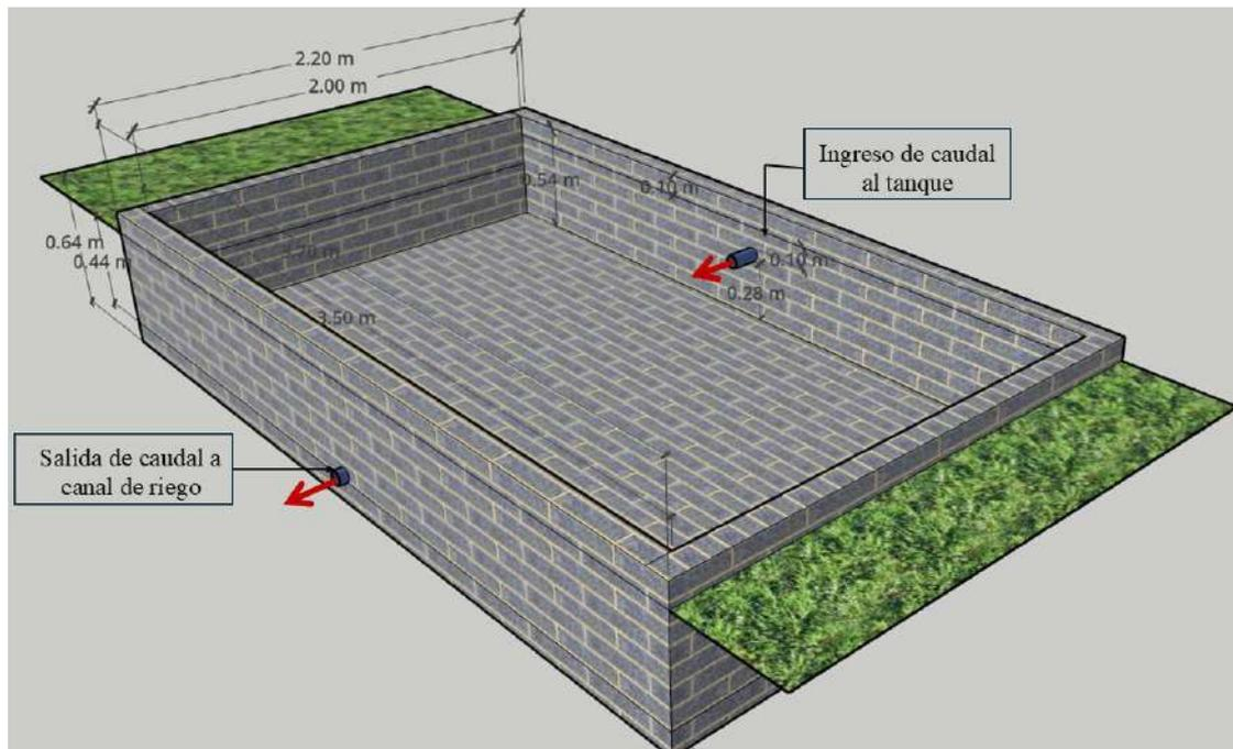
**Figura 47.** Vista isométrica del tanque de almacenamiento propuesto. Elaboración propia con Sketchup.
