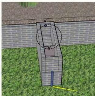
Para realizar la medición de caudal en el vertedor se establece una relación entre el nivel del agua en el canal y el caudal que presenta el sistema en ese momento. Para esto se debe medir la sección del canal que se encuentra antes de la hoja de metal, el procedimiento es muy sencillo, solo se debe ingresar una regla de forma vertical con el valor cero en el extremo inferior de la regla que ingresa al canal.
