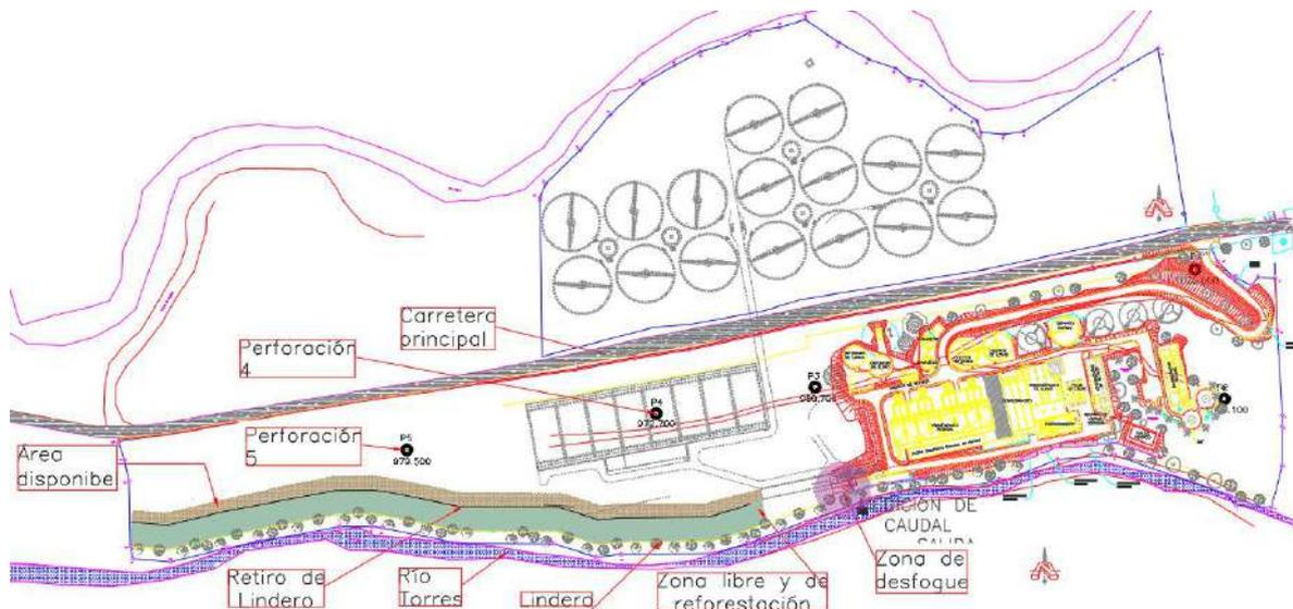
**Figura 22.** Finca de la PTAR Los Tajos con huella constructiva actual y huella constructiva futura correspondiente a la segunda etapa del proyecto. Plano generado por PTAR Los Tajos del AyA.
