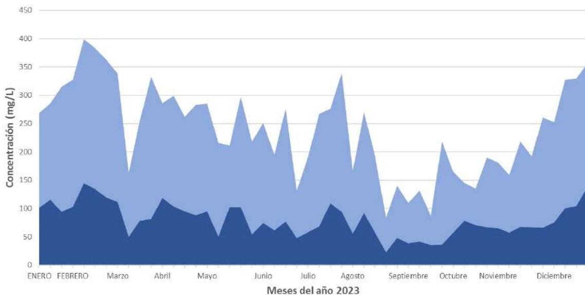
**Figura 16.** Valores de DBO y DQO registrados en la PTAR Los Tajos en el 2023.
