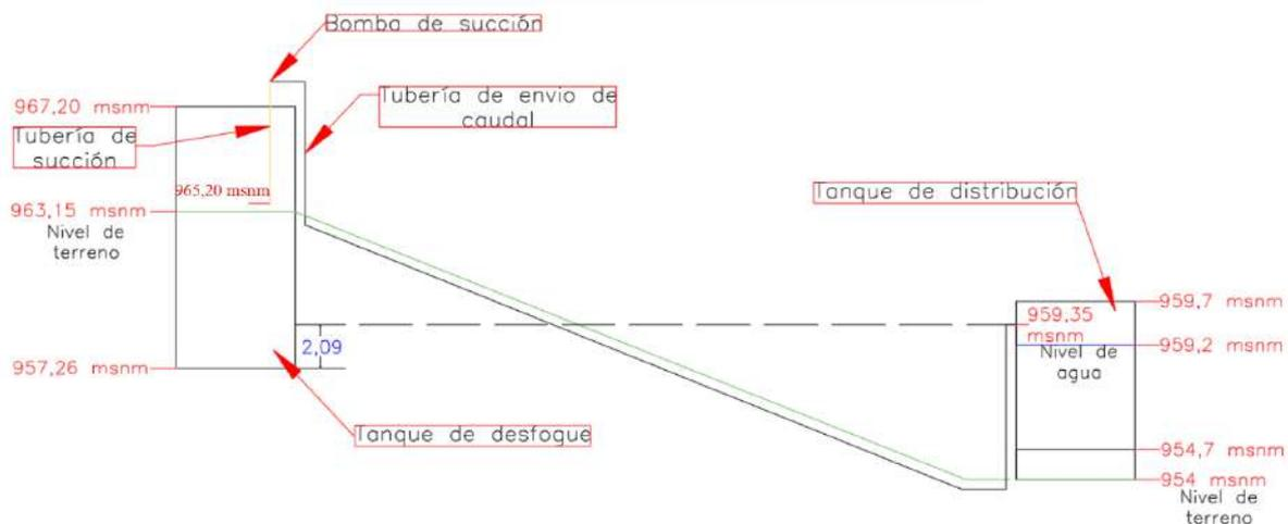
Figura 33. Esquema de alturas de tanques y disposición de la bomba.
