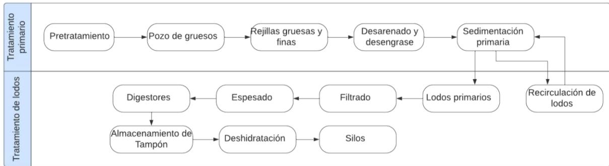
**Figura 7.** Diagrama de flujo del proceso que posee la PTAR Los Tajos.
