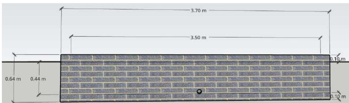
**Figura 46.** Vista frontal del tanque de almacenamiento. Elaboración propia con Sketchup
