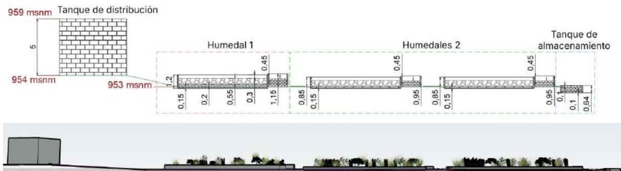
**Figura 52.** Vista de perfil de diseño sugerido en 2D y 3D. Elaboración propia con Sketchup y AutoCAD.
