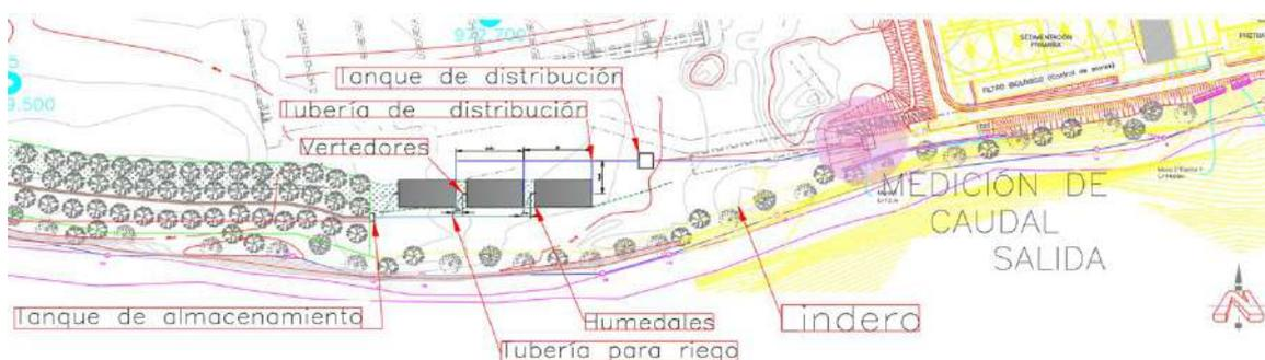
**Figura 29.** Distribución en planta de los humedales artificiales de flujo subsuperficial horizontal y las estructuras que forman parte del sistema de tratamiento secundario.
