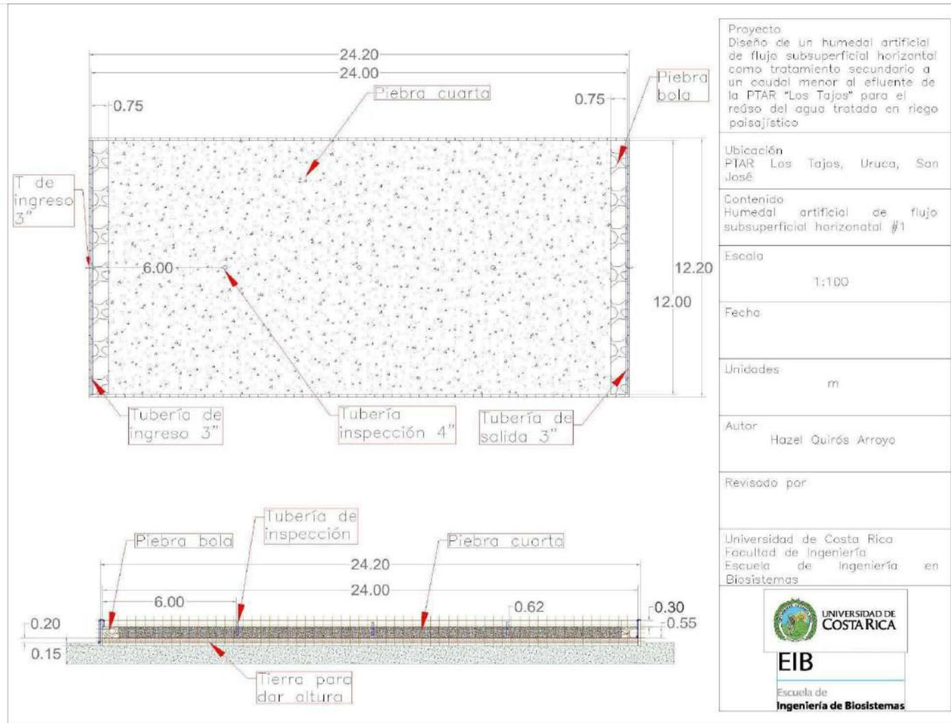
**Figura 27.** Planos de humedal artificial de flujo subsuperficial horizontal establecido como sistema de tratamiento del agua residual. Elaboración propia con AutoCAD.
