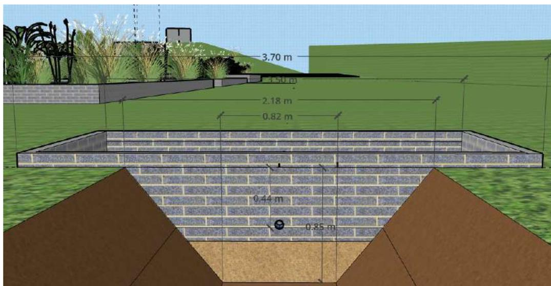
**Figura 48.** Vista lateral del tanque de almacenamiento, tubería de salida de agua hacia zona de riego. Elaboración propia con Sketchup.
