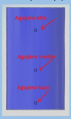
**5.1** Para conectar los dos tanques de filtrado, se deben hacer agujeros en el primer tanque. El agujero bajo es en que se hizo en el paso **4.5**, el agujero medio se debe hacer unos 15 cm por arriba del agujero bajo, ya que este será una salida auxiliar del primer tanque. Por último, el agujero alto se debe hacer unos 10 cm por debajo de la tapa superior del tanque, ya que por este se canaliza el agua hacia el segundo tanque.
