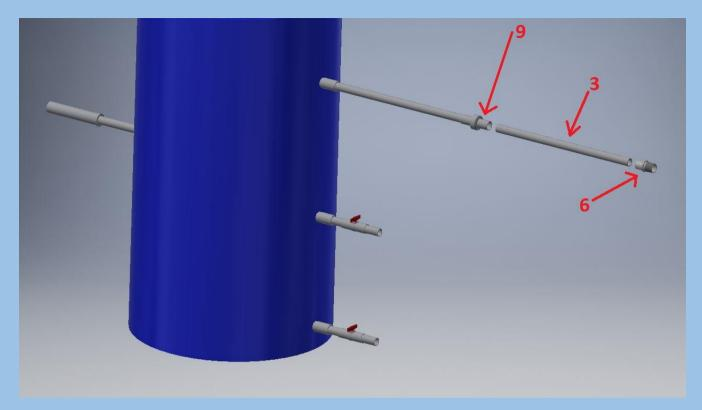
**6.2** Como se muestra en la figura anterior, se debe conectar otro tubo de ½ [3] a la salida libre de la conexión tope y rosca [9] mediante pegamento. Además, en el otro extremo de este tubo [3], se debe pegar una conexión tipo macho [6] que se introducirá en el segundo tanque más adelante.
