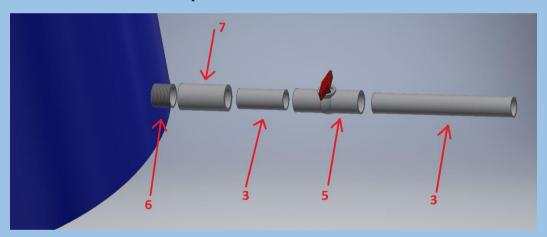
7.5 En el agujero inferior que se hizo en el paso 7.3, se debe introducir desde el interior del tanque un acople macho [6] con la rosca hacia el exterior. A este acople se le debe roscar uno tipo hembra [7] desde el exterior. Con pegamento, se debe colocar un segmento de tubo de ½ [3] entre el acople hembra y una llave de bola [5], para finalmente desembocar en un último segmento de tubería de ½ hacia el exterior.
