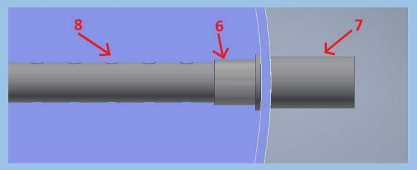
5. Salidas del primer tanque y conexión al segundo.
