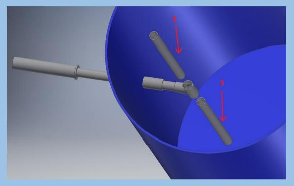
**4.2** En este paso, se deben unir dos piezas de ½ [3] con la conexión tipo T con pegamento. La longitud de estas dos piezas dependerá del tamaño del tanque, solo se debe considerar que los tubos de ½ quede al menos a 10 cm tanto de la tapa inferior como superior del tanque.
