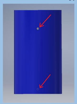
**7.3** El agujero que se muestra en la parte alta del tanque debe estar aproximadamente 10 cm abajo de la tapa superior del tanque. Por otra parte, el agujero de la parte inferior debe estar aproximadamente a 5 cm por encima de la parte inferior del tanque.
