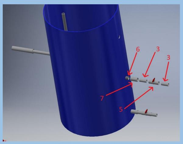
**5.3** Al igual que en el paso **4.5**, solo que en el agujero de altura media, se utilizará un acople tipo macho [6] desde el interior del tanque con la rosca hacia el exterior para unirlo al acople hembra [7]. Con una sección de tubo de ½ [3] de longitud mínima, se debe unir el acople hembra mediante pegamento a una llave de bola [5], y esta por último a una sección de tubo de ½ que da al exterior (Las dos secciones de tubo de ½ pueden ser del mismo tamaño).
