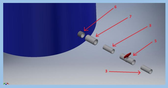
**5.2** En la figura anterior, los acoples macho [6] y hembra [7] son los que se instalaron en el paso **4.5**. El acople tipo hembra se debe conectar con pegamento a una sección de tubería de ½ [3] el cual se debe conectar a una llave de bola [5], también con pegamento. Ambos segmentos de tubo [3] pueden ser de las longitudes mínimas que permitan las conecciones.
