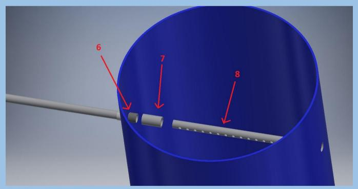
**7.1** En este paso se debe enroscar un acople hembra [7] al acople macho [6] que se había instalado en el paso **6.2**. Seguidamente, al acople hembra se le debe conectar con pegamento un tubo de  $\frac{1}{2}$  [8] con agujeros de unos 40 cm de longitud.
