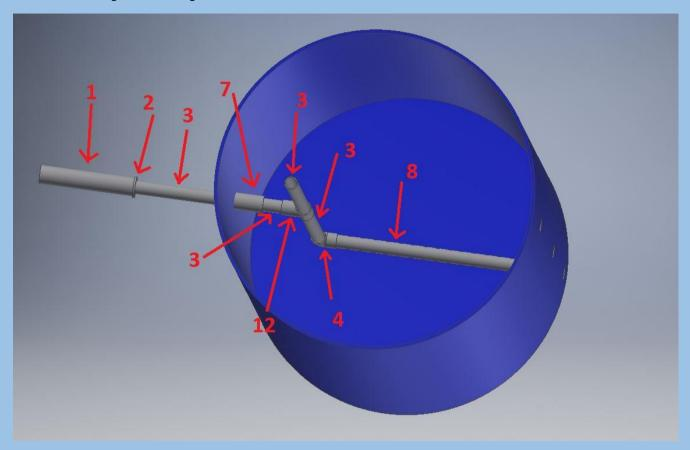
En este paso se realizarán las uniones de las partes que van en el interior del primer tanque. La figura anterior es simplemente una vista superior para tener una idea general del orden de las piezas a lo interno. A continuación se muestra cómo llegar a esto de manera detallada.
