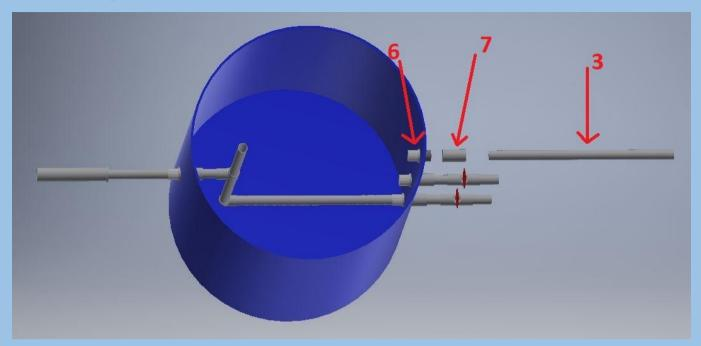
**5.4** En la figura anterior se muestra que el agujero alto se deben usar un acople macho [6] y uno hembra [7] al igual que en todos los demás agujeros (revisar paso **4.5** como guia). Lo único diferente en este paso es que el tubo de ½ [3] que se conecta en el exterior debe ser de al menos 40 cm (Este valor puede cambiar si la distancia entre los dos tanques es mayor o menor)
