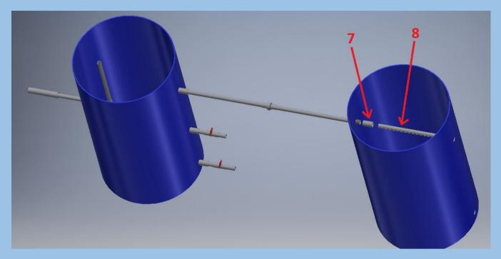
La imagen anterior es para ilustrar que ahora se está trabajando en el segundo tanque. Aqui se conectará el extremo del acople macho del paso **6.2** con uno hembra [7] dentro del tanque a un tubo con agujeros [8].
