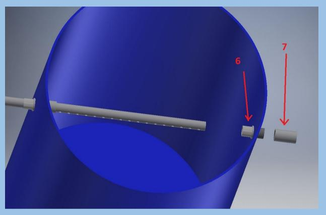
**7.4** En la figura anterior se ilustra la conexión macho [6] - hembra [7] que se debe hacer en el agujero de la parte alta que se mostró en el paso **7.3**. Aquí se puede repetir nuevamente el paso **4.5** para hacer la unión.
