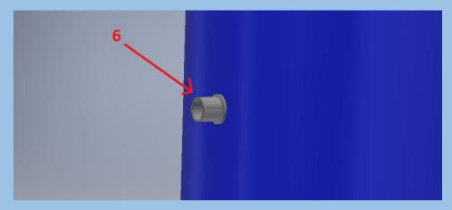
En el agujero que se hizo en el paso 2, se debe introducir el acople macho con la rosca hacia el interior del primer tanque.
