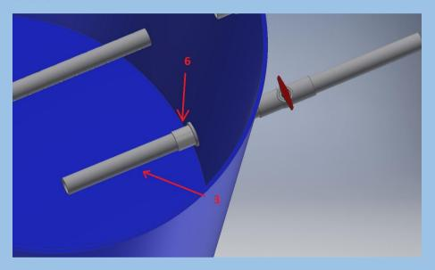
**7.6** Por último, en el interior del segundo tanque, se debe acoplar un segmento de tubería de ½ [3] (de unos 25 cm de longitud) al acople macho[6] que se instaló en el paso **7.5**.
