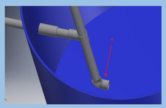
**4.3** En este paso se debe colocar un codo [4] de ½ de 90 grados de manera paralela a la entrada de agua. La unión se debe realizar con pegamento.
