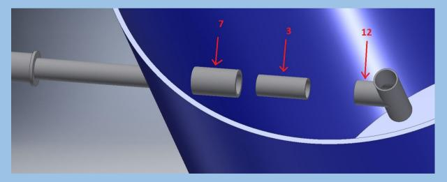
**4.1** La conexión hembra [7], que se muestra en la figura anterior es la correspondiente a la que se instaló en el paso 2. De nuevo, la tubería de ½ [3] puede ser de la distancia mínima que permita las uniones con el acople hembra y la conexión tipo "T", sin embargo antes de unir estas piezas con pegamento se recomienda leer el la aclaración que se hace en la página siguiente.
