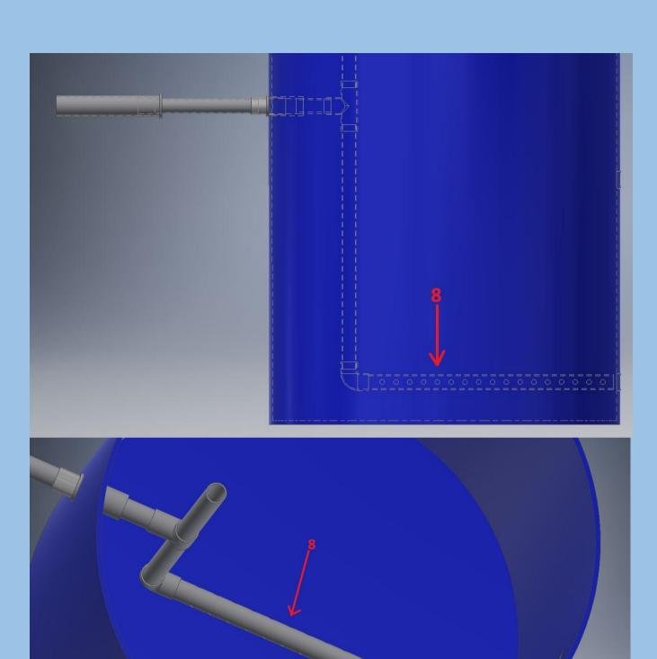
**4.4** Como se muestra en las dos vistas anteriores, el tubo con agujeros [8] se debe conectar con el codo de 90 grados que se instaló en el paso **4.3.** Para determinar la longitud del tubo con agujeros, se debe medir la distancia entre el codo de 90 grados y la pared del tanque, para lo cual se pueden unir las partes del paso **4.2** y **4.3** sin pegamento a la entrada del tanque.
