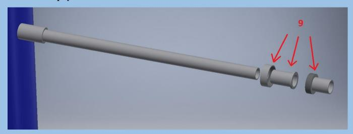
**6.1** La figura anterior muestra los tres componentes una unión tipo rosca y tope [9]. Los componentes se deben colocar en el orden que se muestran en la figura y se deben asegurar con pegamento al tubo que sale del primer tanque. Las dos partes roscadas se deben unir para que queden fijas.
