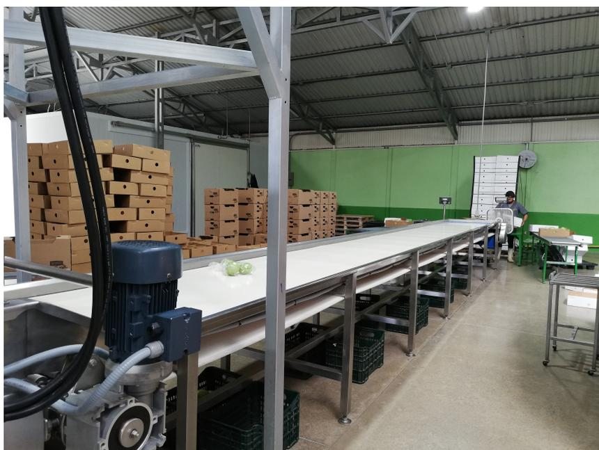
**Figura 20:** Banda transportadora para embolsado y empaque.
