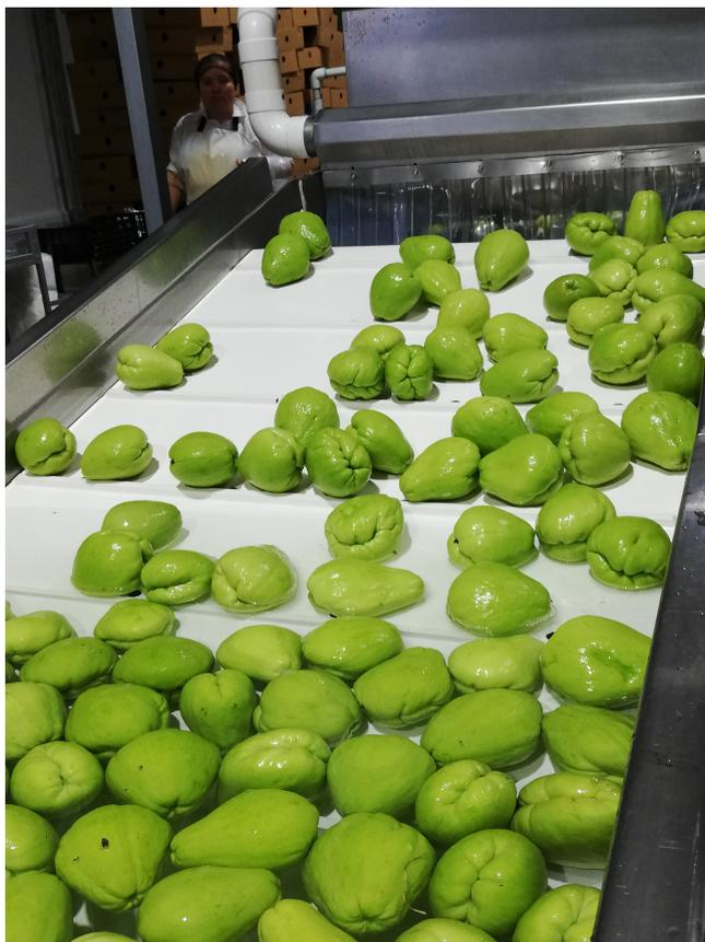
**Figura 15:** Banda transportadora para sacar producto del tanque.
