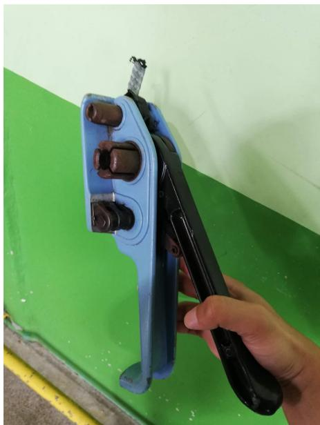
**Figura 30:** Prensa para colocar cinta y prensas en las paletas conformadas.
