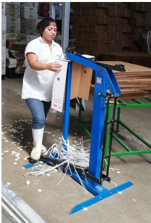
**Figura 21:** Máquina para armado de cajas.
