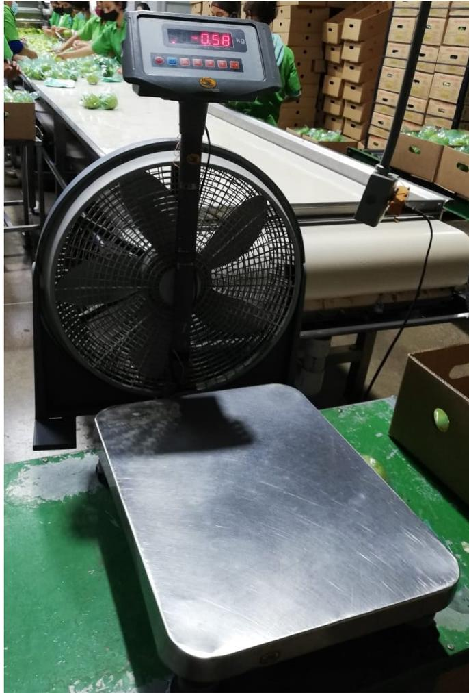
**Figura 27:** Balanza de plataforma
