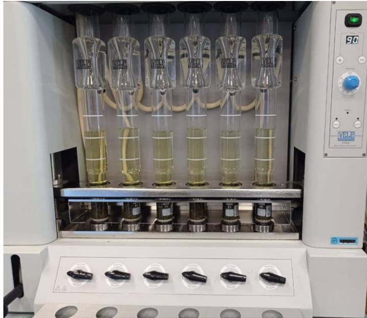
**Figura 7.** Extractor de fibra cruda con muestras de hoja y tratamiento con alcohol etílico
