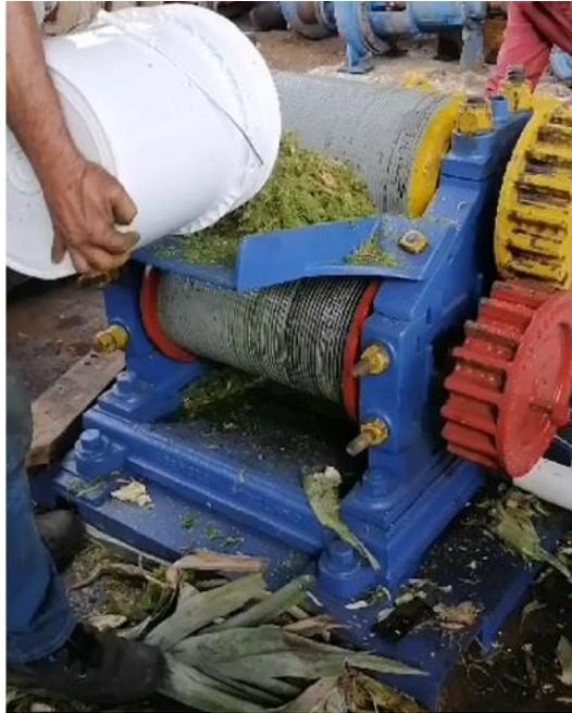
**Figura 5.** Molino adaptado para moler el rastrojo de piña desfibrado
