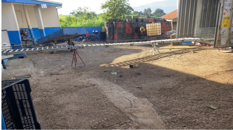
Figura 6. Banda de rodillos utilizada para conectar la puerta de descarga del cuarto frío con el contenedor.
