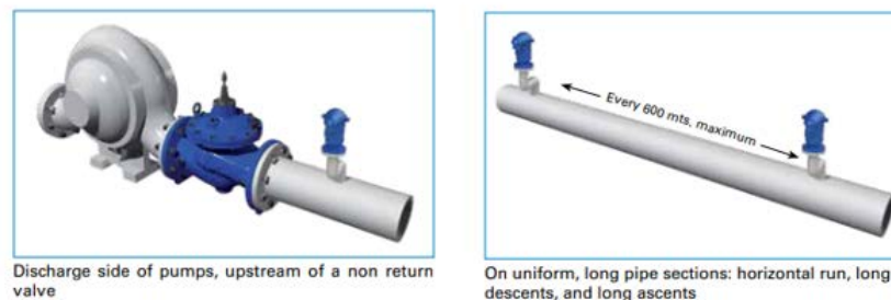
Figura 55. Detalle de instalación de válvulas de aire.
