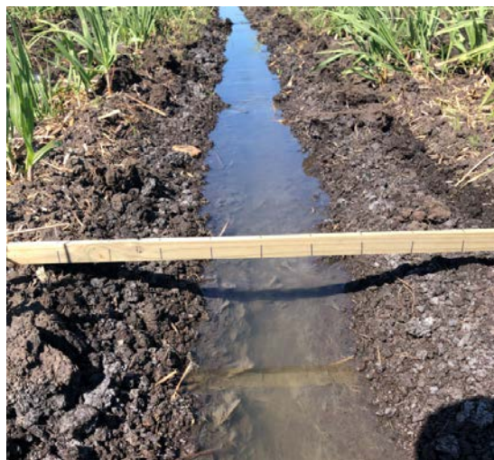
Figura 9. Medición de sección transversal, parcela I8.
