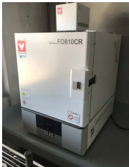
Figura 7. Mufla utilizada en las pruebas de pérdida por ignición.
