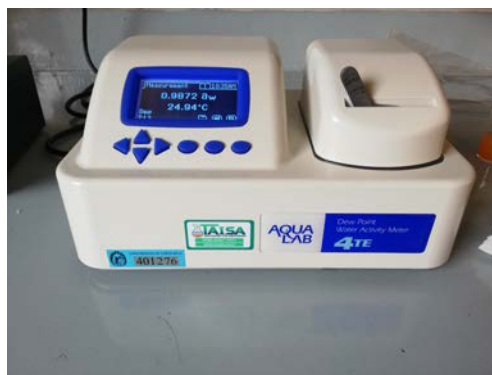
Figura 10. Medidor de actividad de agua, (modelo AQUALAB 4TE de METER) usado para determinar la actividad de agua de la uchuva.
