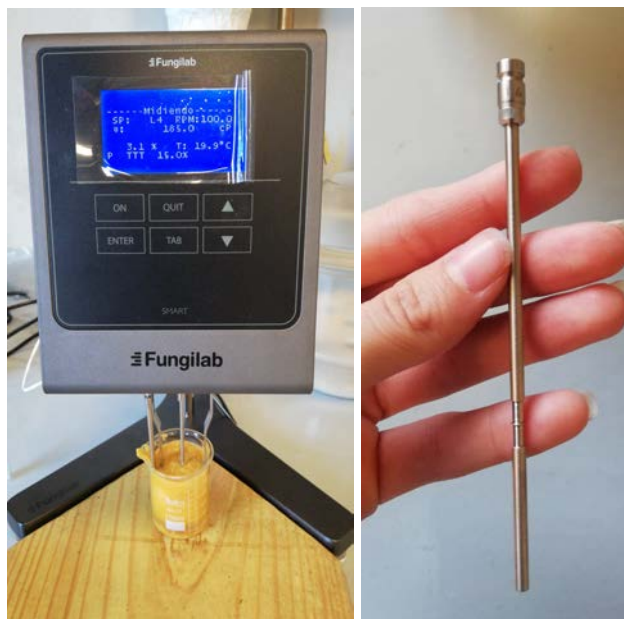
Figura 13. Viscosímetro (marca: Fungilab) utilizado para realizar las pruebas.
