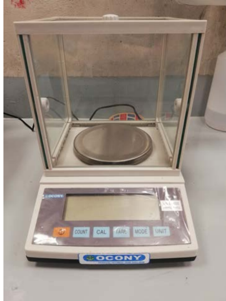
Figura 5. Balanza analítica digital (marca OCONY, modelo ES-1000h) usada para medir la masa de la fruta ( \pm 0,01 g).
