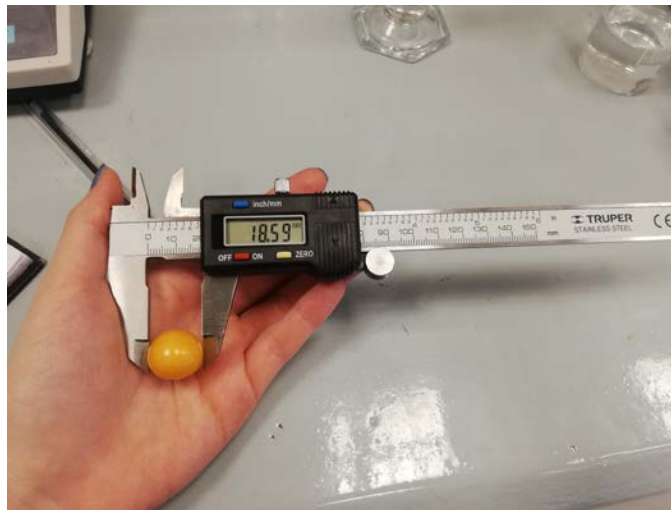
Figura 6. Medición del diámetro de la uchuva con un vernier (marca Truper) \pm 0.01 mm.
