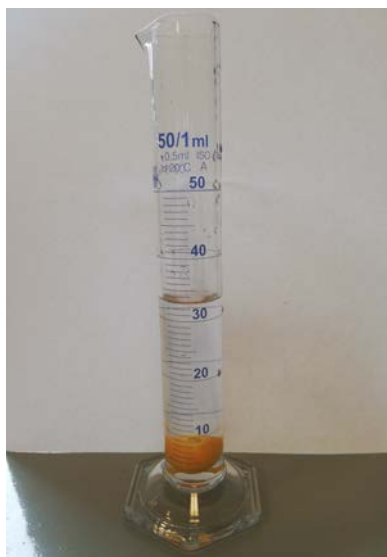
Figura 7. Medición de volumen de la fruta con probeta.
