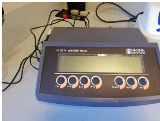
Figura 9. pHmetro (Marca Hanna Instruments, modelo HI 2211) usado para determinar el pH de la fruta.
