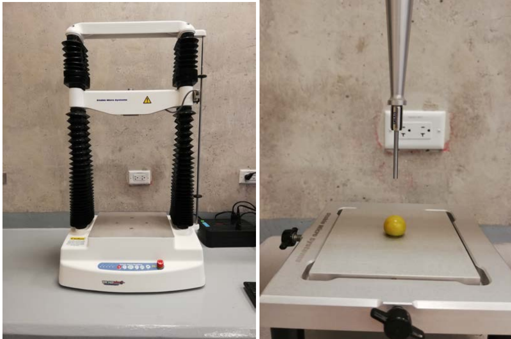
(a) Texturómetro (Stable Micro Systems, (b) Punta cilíndrica de 3 mm utilizada para me- TA.HD plus C) utilizado para medir la firmeza. dir firmeza.
