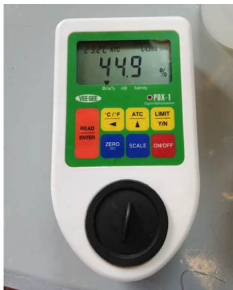
Figura 8. Refractómetro digital (Marca Vee Gee, modelo PDX-1) usado para determinar los sólidos solubles por medio de una escala de grados Brix.
