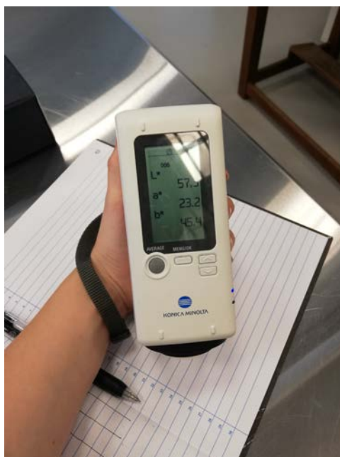
Figura 11. Colorímetro (marca KONICA MINOLTA, modelo CR-20) utilizado para medir el índice de color de la uchuva entera y fresca.
