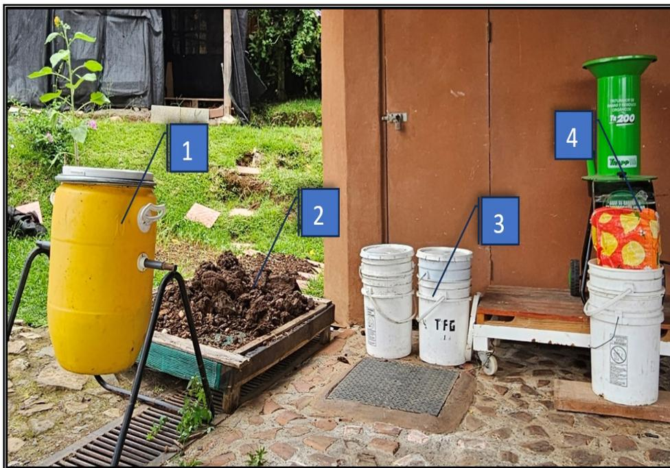
*Figura 6. Componentes del sistema de compostaje utilizado para recibir y procesar los RSB, previo a la adición a las composteras.*
