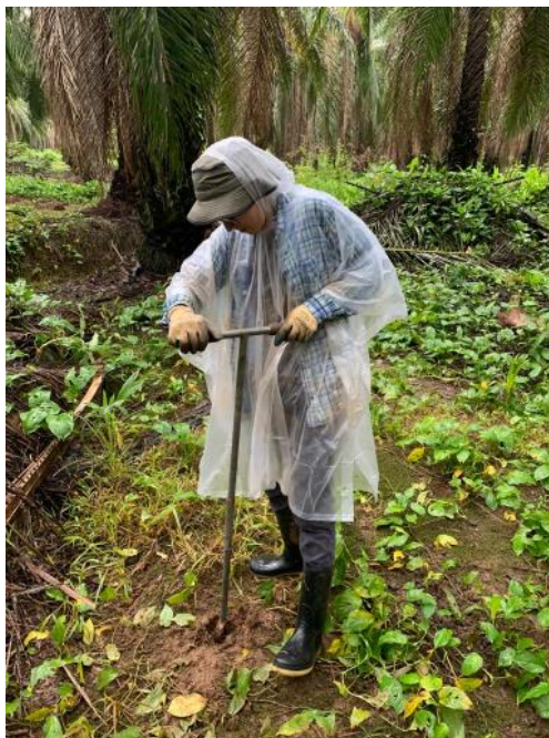
Anexo 2. Toma de muestras de suelo con barreno.
