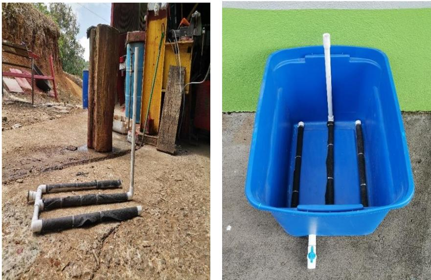
Fig. 5. Diseño de sistema de drenaje de los modelos de humedales artificiales.
