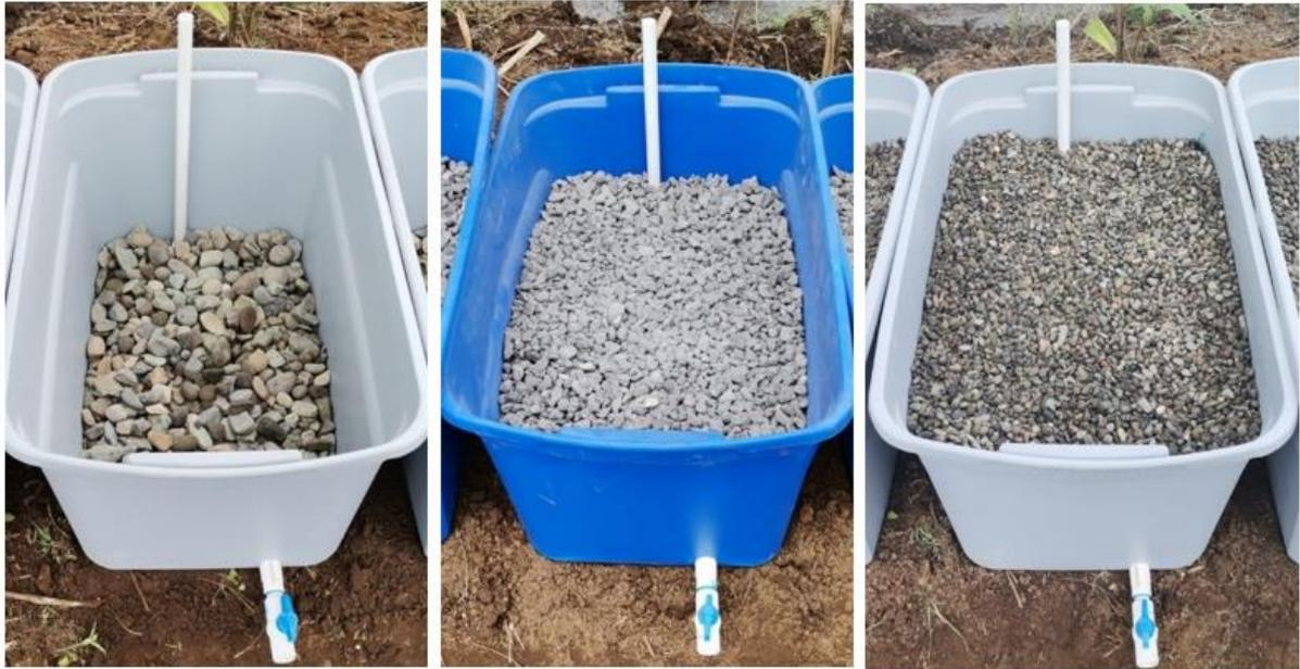
Fig. 7. Sustratos que se utilizaron en los modelos, piedra de río tipo canto rodado (izquierda), piedra cuarta de origen volcánico (centro) y granito de río (derecha).
