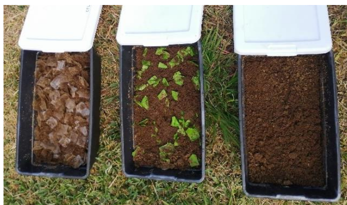
Figura 14. Reactores de compostaje tipo caja con la adición de PLA, PBAT y control al RS, respectivamente.
