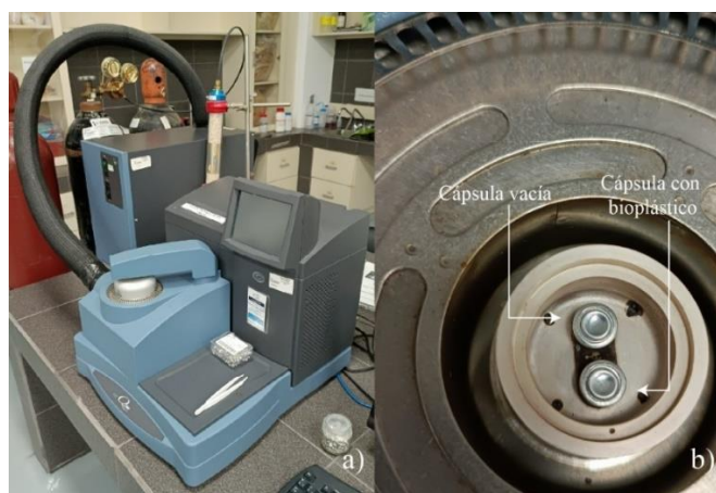
Figura 16. Análisis de DSC. a) Equipo DSC. b) Detalle de cápsulas empleadas en el análisis.
