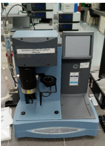
Figura 15. Analizador termogravimétrico (TGA) empleado para analizar muestras de PLA y PBAT durante la duración del proceso de compostaje.
