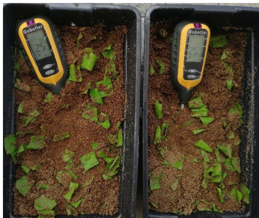
Figura 43. Medición de temperatura interna de compost
