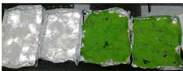
Figura 8. Bioplásticos de PLA y PBAT cortados y secados a 40^\circ\text{C} alcanzar masa constante.
