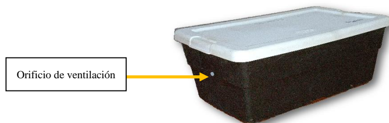
Figura 9. Reactores de compostaje tipo caja (RC) utilizados para el proceso de compostaje de PLA y PBAT durante 6 meses.
