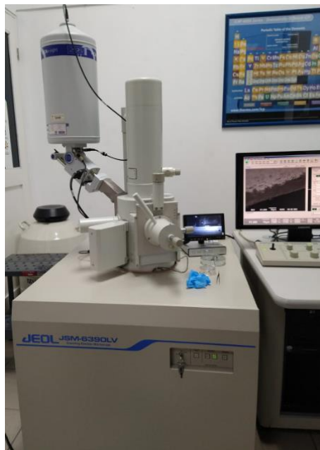
Figura 1. Microscopio electrónico de barrido JSM-6390LV, Jeol.
