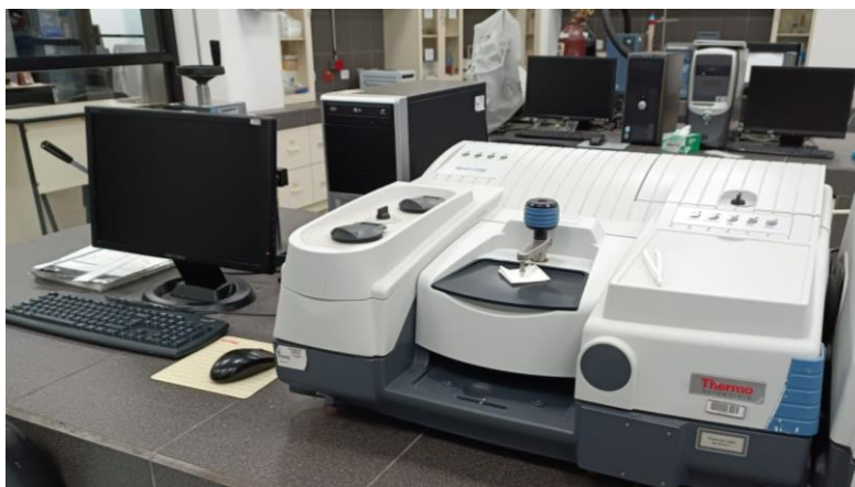
Figura 2. Espectrómetro infrarrojo Nicolet iS50 FT-IR, Thermo Fischer Scientific.
