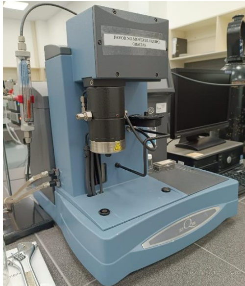
Figura 3. Analizador termogravimétrico TGA-Q500, TA Instruments.
