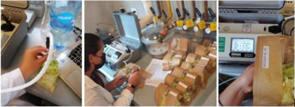
**Figura 6.** Medición de composición de gases en las ensaladas mixtas precortadas.
