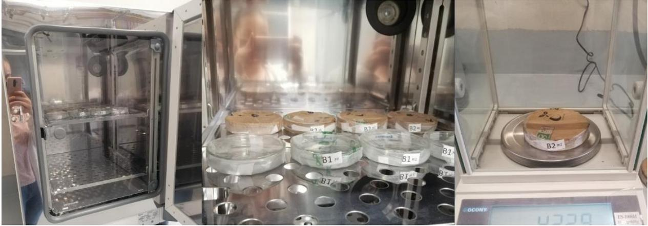
**Figura 10** Preparación y almacenamiento de muestras para evaluar la permeabilidad al vapor mediante la norma ASTM E-96.
