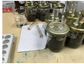
B) Extracción de CO 2 capturado con jeringas de vidrio.
