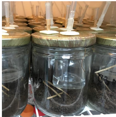
b) Sistema Biométrico en ejecución de ensayo de respiración y mineralización.
