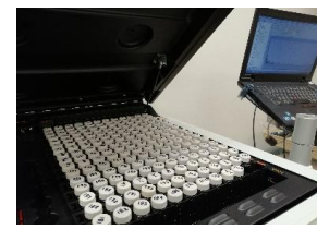
F) Tri-Carb de Perkin Elmer: Lectura (dpm) de muestras.
