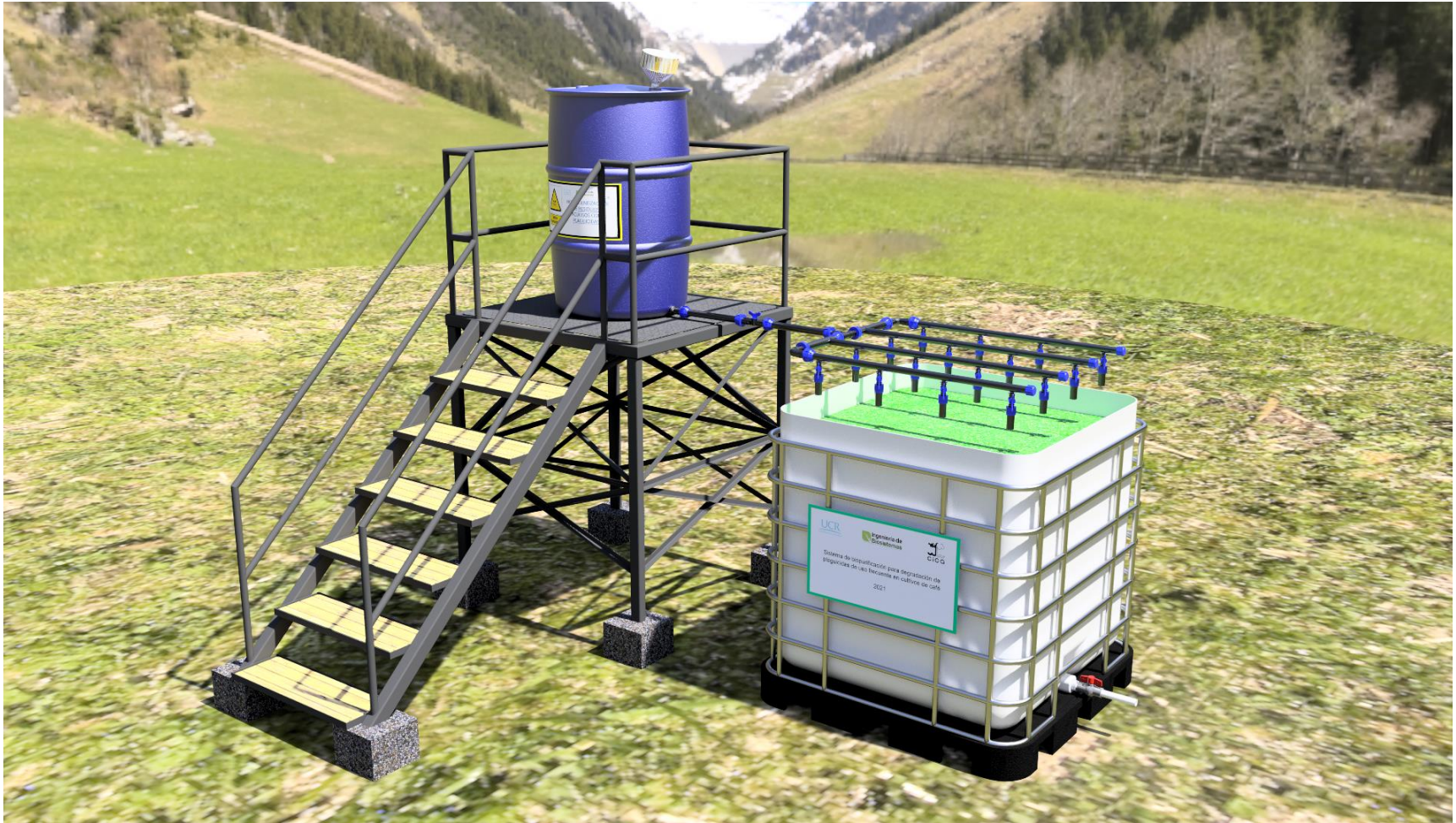
Figura 33. Diseño final del sistema de biopurificación (BPS) para eliminación de plaguicidas utilizados en café.
