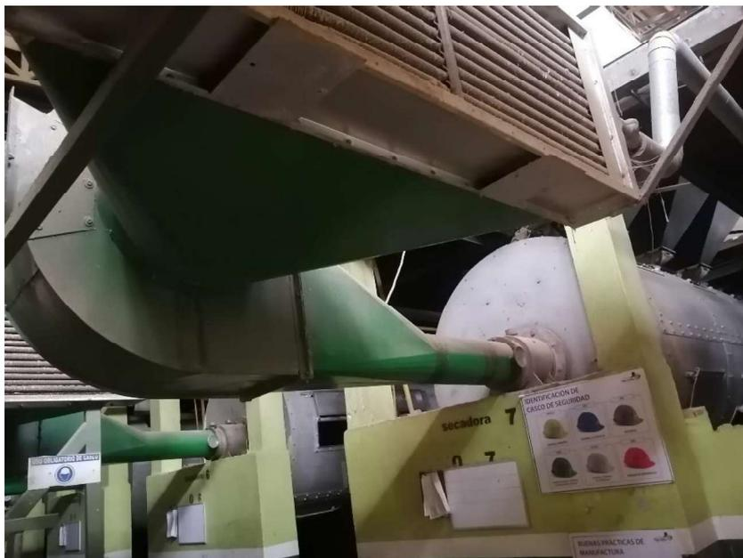
**Figura 13.** Disposición del intercambiador de calor, abanico y secadora en sector de secado con secadoras de 60 quintales.
