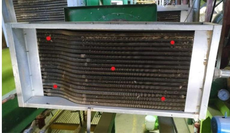
**Figura 18.** Puntos de medición de velocidad del aire de secado.
