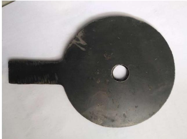
**Figura 15.** Placa de orificio construida.
