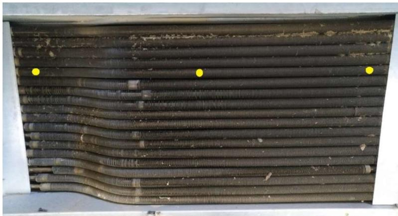
**Figura 19.** Puntos de medición de la temperatura de la superficie de los tubos.
