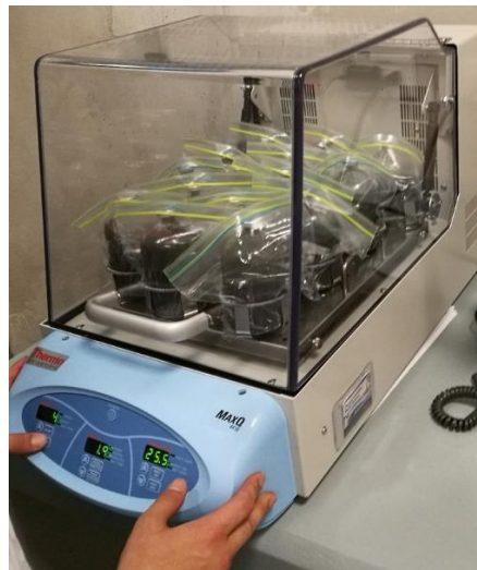
Figura 15. Microdigestores en el equipo de agitación
