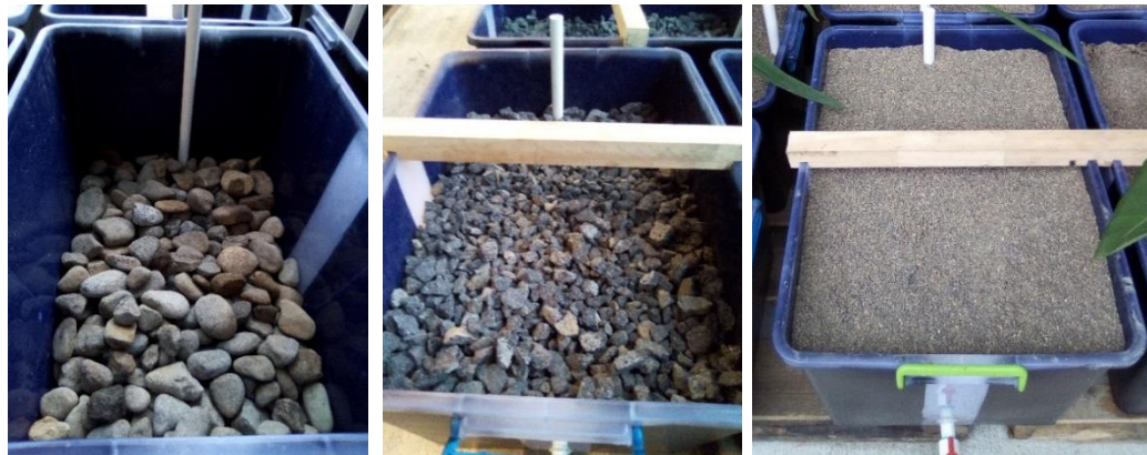
Figura 3. Sustratos que conforman el lecho del humedal artificial, canto rodado (izquierda), piedra volcánica (centro) y granito de río (derecha) (Fotografías tomadas el 08/10/2018 por el autor)
