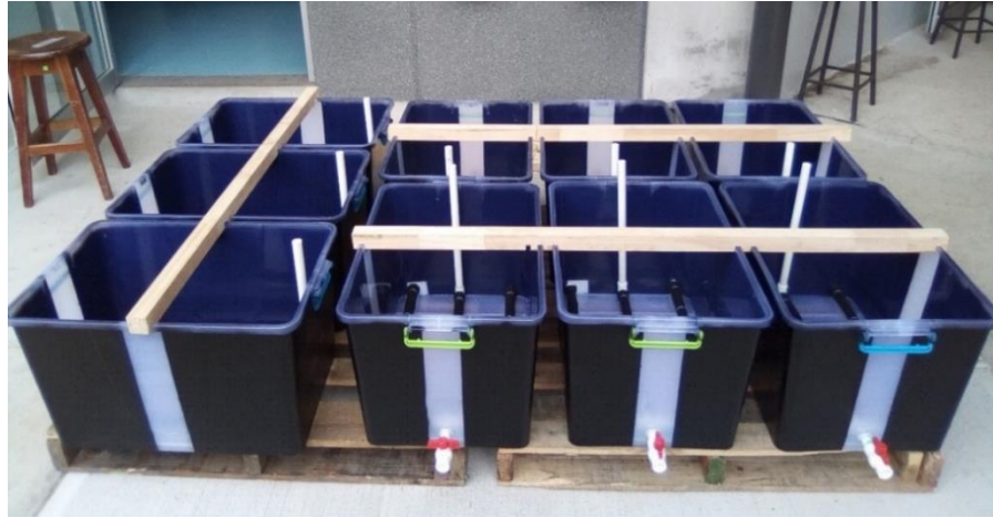
Figura 2. Sistema de HFSSV a escala de laboratorio. (Fotografía tomada el 05/10/2018 por el autor)
