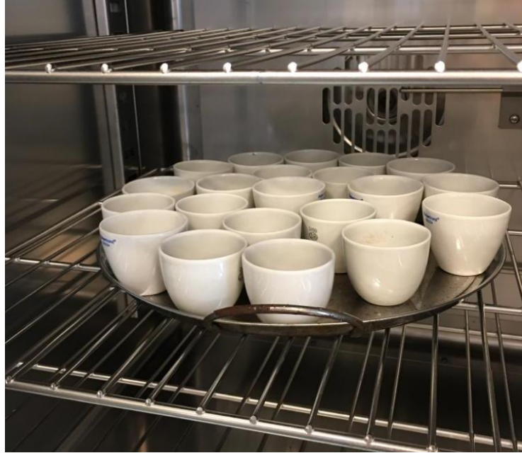
Figura 14. Muestras dentro del horno para las pruebas de sólidos totales y volátiles
