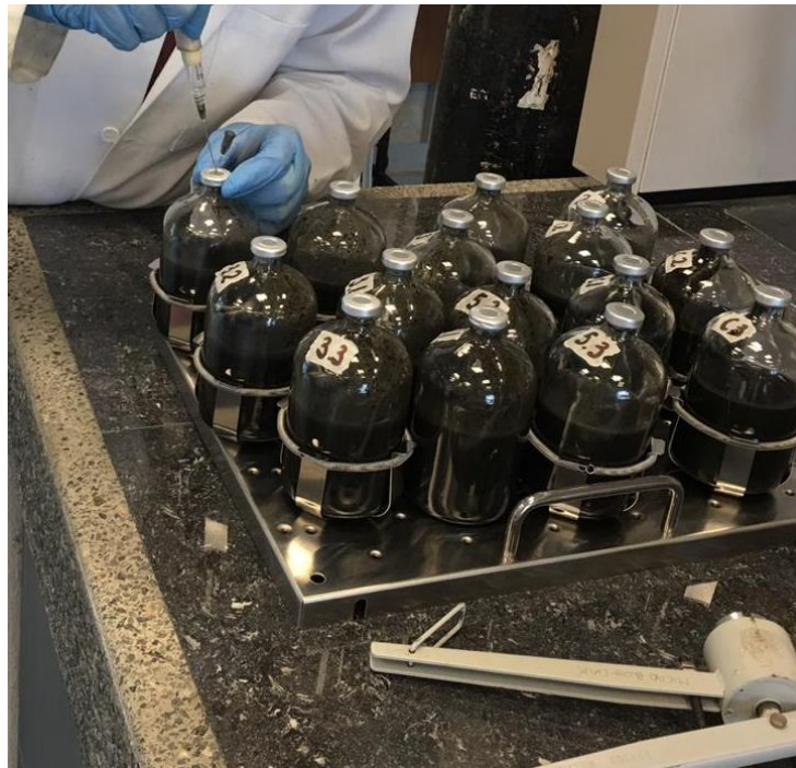
Figura 18. Procedimiento para llenar botellas serum de nitrógeno
