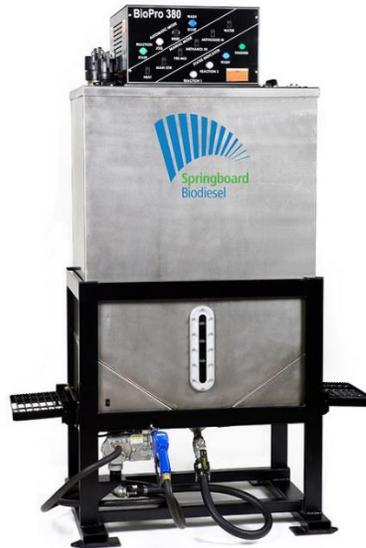
**Figura 4.** Reactor para la producción de biodiésel [67].
