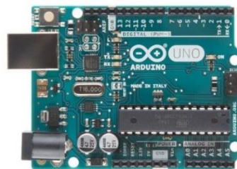
Figura 5. Arduino UNO R3, utilizado para la programación del sistema de monitoreo y control de la secadora.
