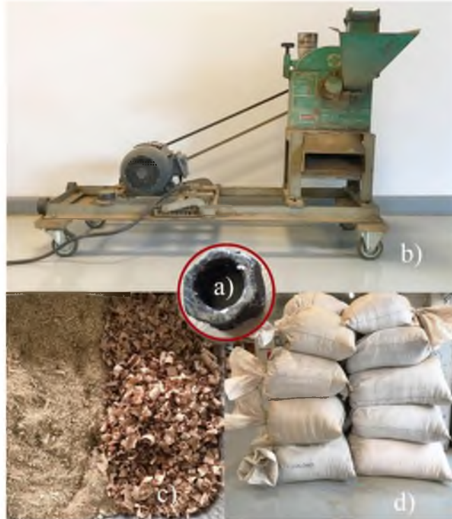
Figura 2.1. Equipo para el acondicionamiento de la biomasa.
