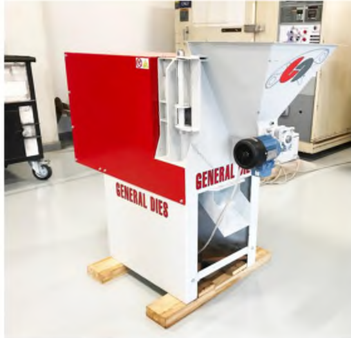
Figura 2.2. Peletizadora de rodillos con matriz de anillo, General Dies, modelo M20.
