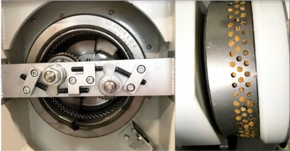
Figura 2.3. Matriz con forma de anillo y rodillos.
