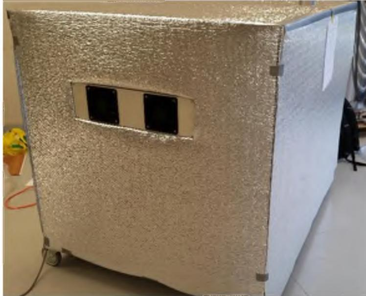
**Figura 3-39.** Ventiladores instalados en la parte trasera del equipo.
