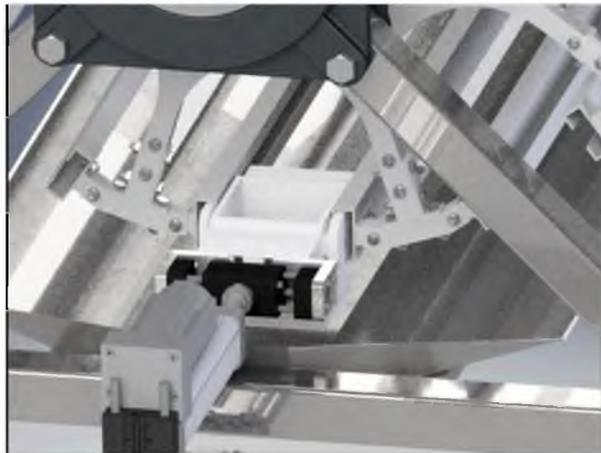
**Figura 3-3.** Modelo conceptual de sistema automatizado para manipulación de contenedores en el sistema hidropónico orbital donde los contenedores de plantas son colocados y deslizados en los rieles.
