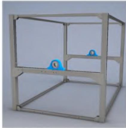
**Figura 3-11.** Marco externo con soportes, uniones no permanentes y roles.
