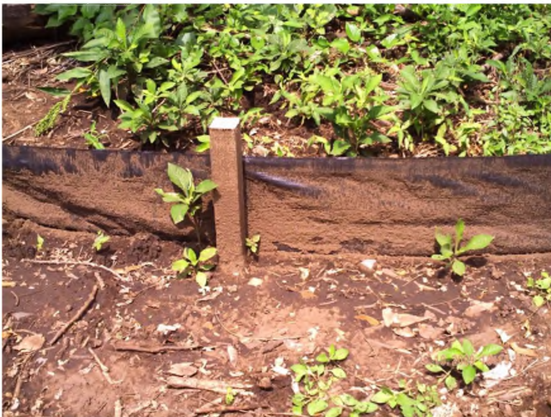
Figura 4.33. Erosión por salpicadura presentada en la geomembrana de la parcela experimental PS 15-30-2.
