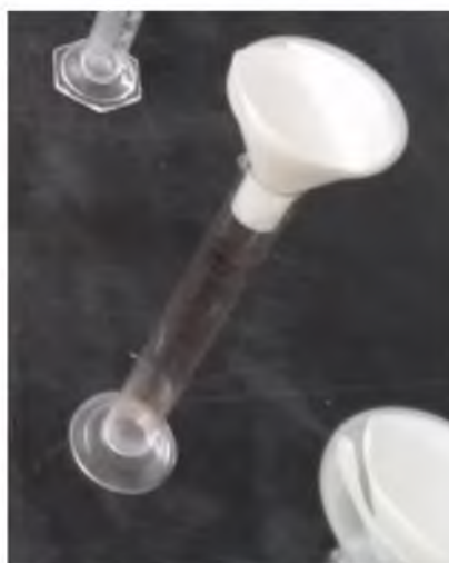
Figura 4. Acople de la probeta con el embudo y el papel filtro (#4) para la prueba de retención de agua por gramo de suelo con la que se evaluaron los suelos de esta investigación.
