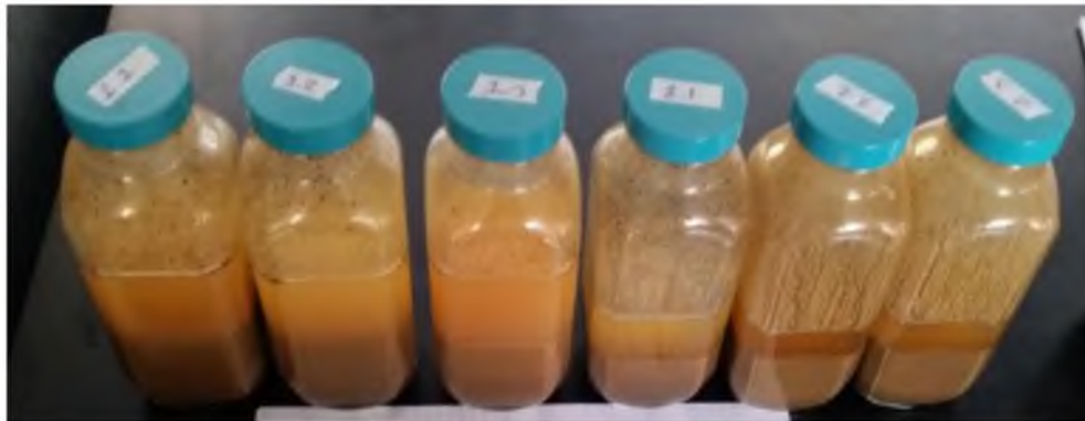
Figura 5. Preparación de la prueba de textura con la que se evaluaron los suelos analizados
