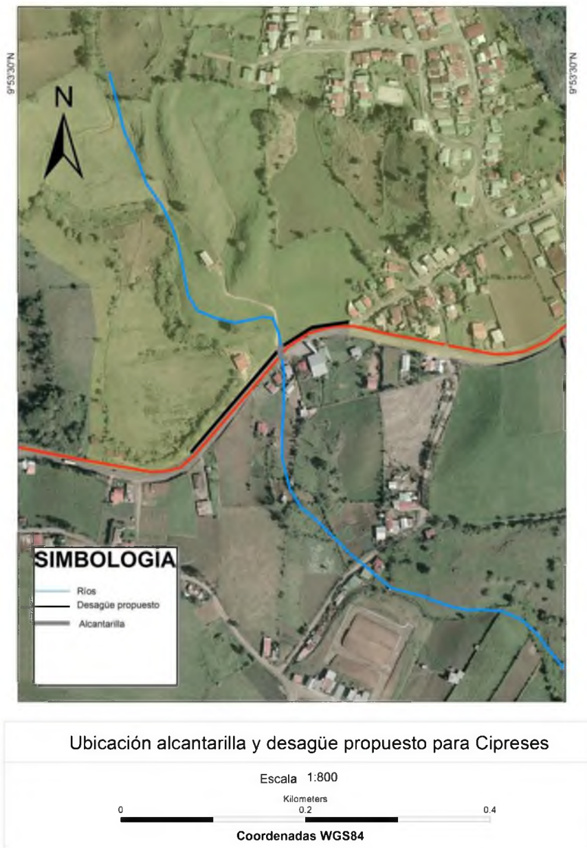
Figura 6-5. Ubicación alcantarilla y desagües propuestos para Cipreses.
