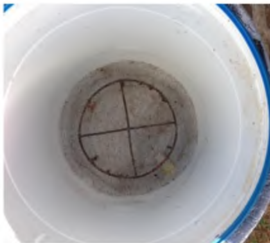
Figura 2.2. Piso falso en el reactor
