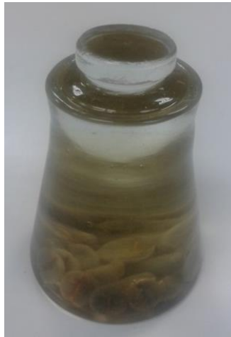
Figura 10. Picnómetro lleno de aceite con 25 granos de café adentro.
