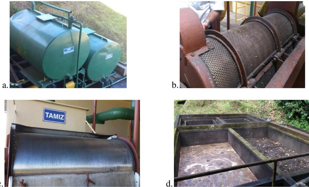
**Figura 7.** a. Tanque de recirculación de agua y tanque de agua. b. Desmucilagadora mecánica. c. Sistema de tamices. d. Tanques de sedimentación anterior a las lagunas anaerobias.
