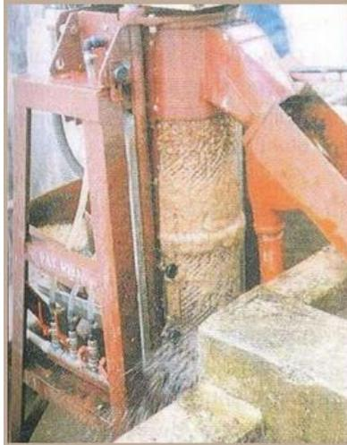
**Figura 4.** Máquina extractora del mucílago, es normalmente llamada lavadora o desmucilagadora. Fuente: Anacafé (2013).
