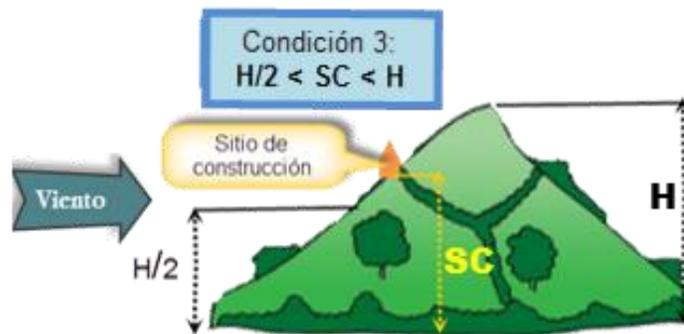
**Figura 4. 3** Condición 3 para el uso de factor topográfico
