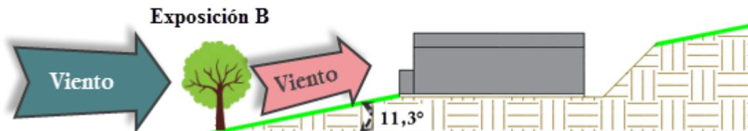
Figura 3. 6 Invernadero a nivel en condiciones de ladera del 20%, exposición B
