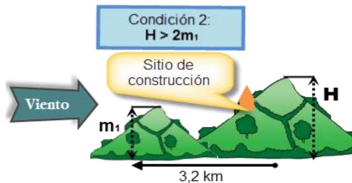
**Figura 4. 2** Condición 2 para el uso de factor topográfico
