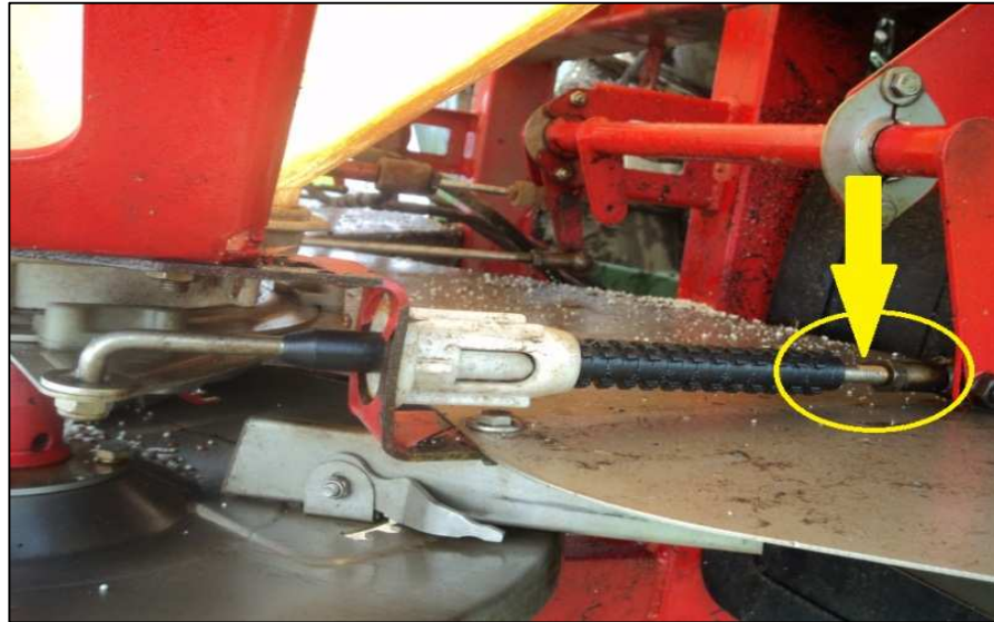
Figura 4.6. Ajuste de apertura de corredera voleadora convencional Fuente: Autor
