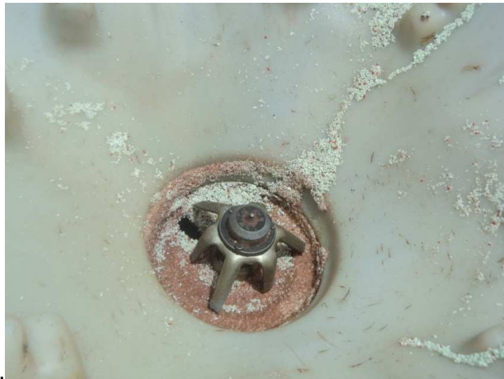
Figura 4.7. Acumulación y obstrucción de fertilizante voleadora JAN Fuente: Autor
