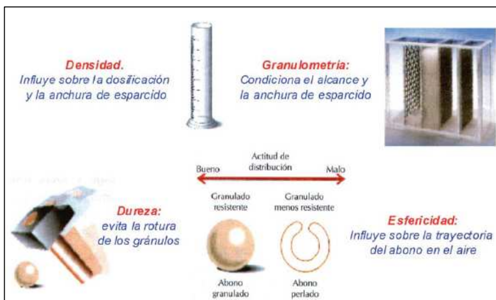
Figura 2.2. Características físicas minerales granulados Fuente: Artículo Luis Márquez, Revista Agrotécnica (2011)
