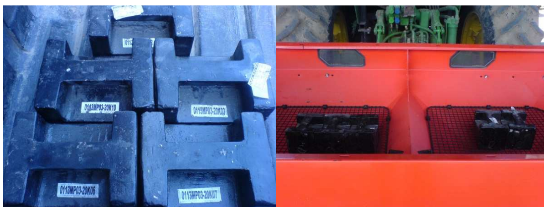
Figura 4.9. Patrones de prueba y pesaje Fuente: Autor
