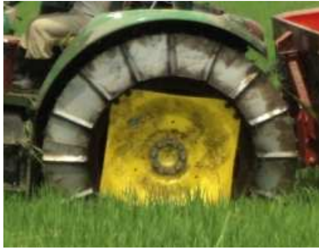
Figura 4.8. Rodaje metálico para condiciones de suelo húmedo Fuente: Autor
