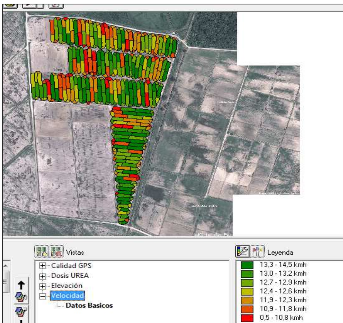
Figura 4.20. Distribución de velocidades durante la aplicación Fuente: Autor
