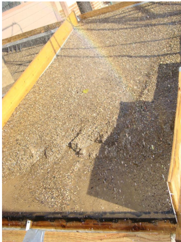
Ilustración 0-11 Prueba: Control, 15%, Suelo Compacto
