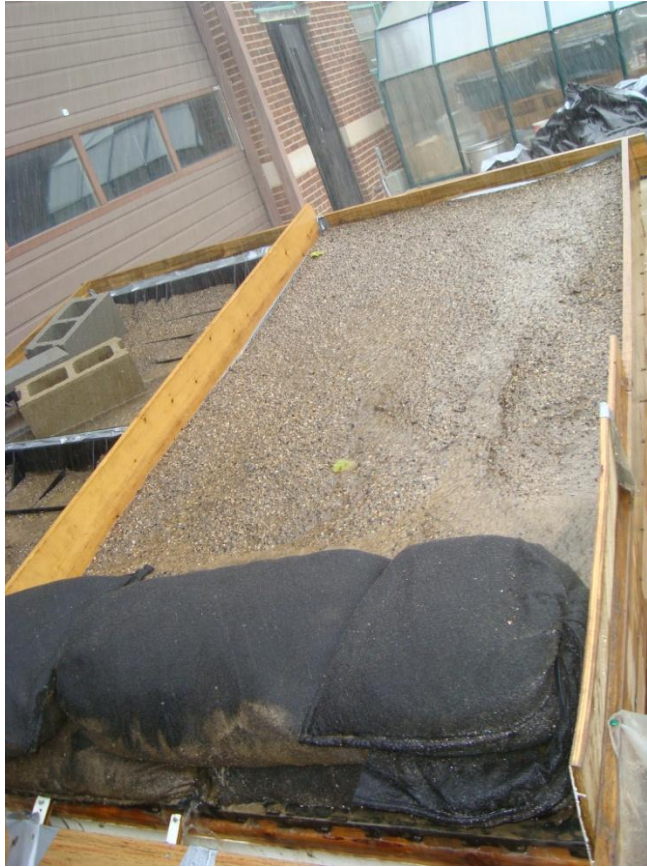
Ilustración 0-10 Prueba: Tratamiento Cemento+Arena, 15%, Suelo Compacto
