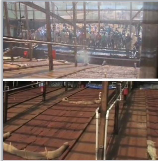
Ilustración 0-2 Parcelas de erosión a escala mayor.
