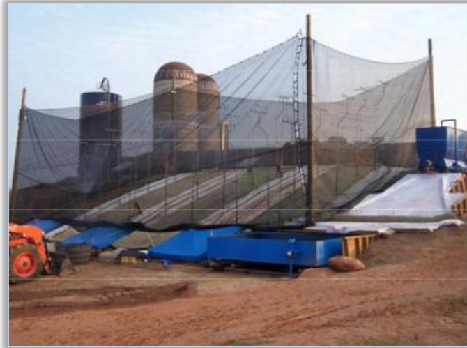
Ilustración 0-3 Parcela de erosión con cortina de vientos.
