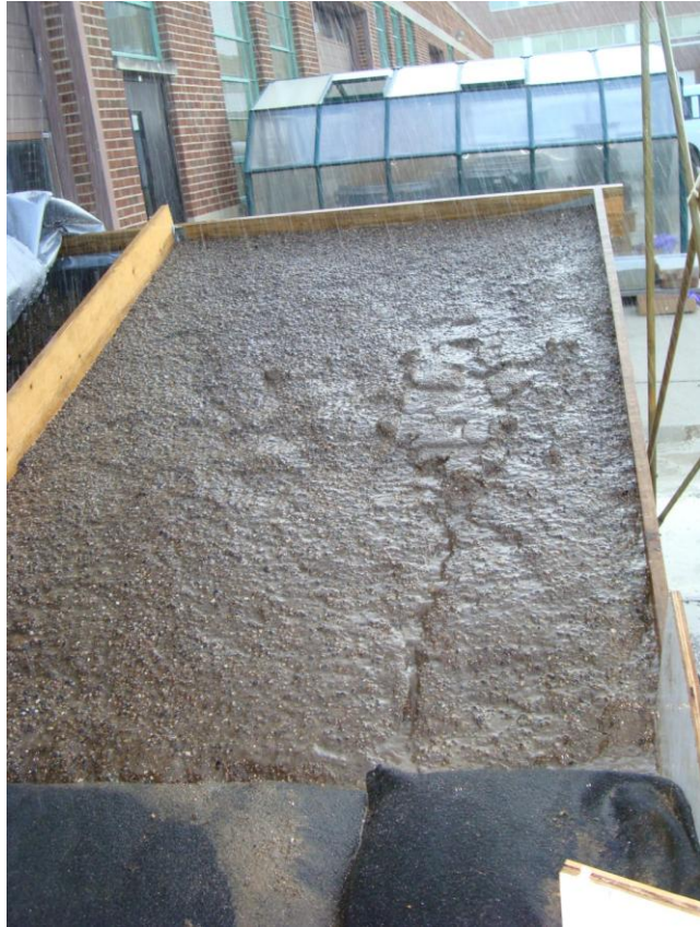
Ilustración 0-8 Prueba: Tratamiento Compost+Arena, 30%, Suelo Compacto
