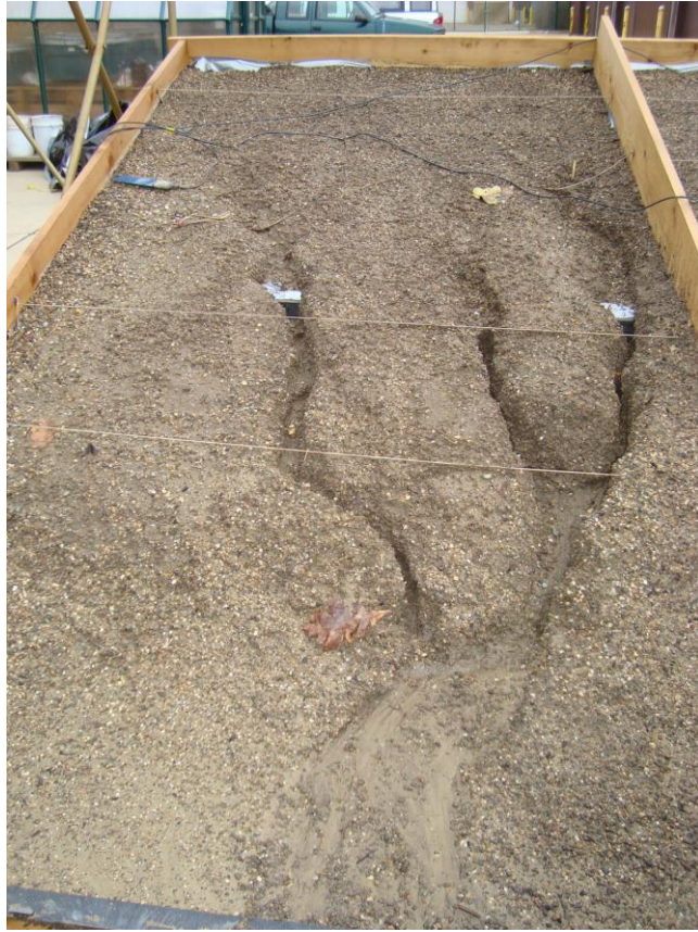
Ilustración 0-6 Prueba: Control, 30%, Suelo Suelto
