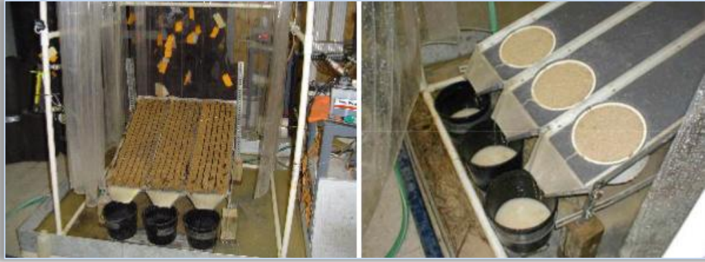
Ilustración 0-1 Parcelas de erosión a pequeña escala.
