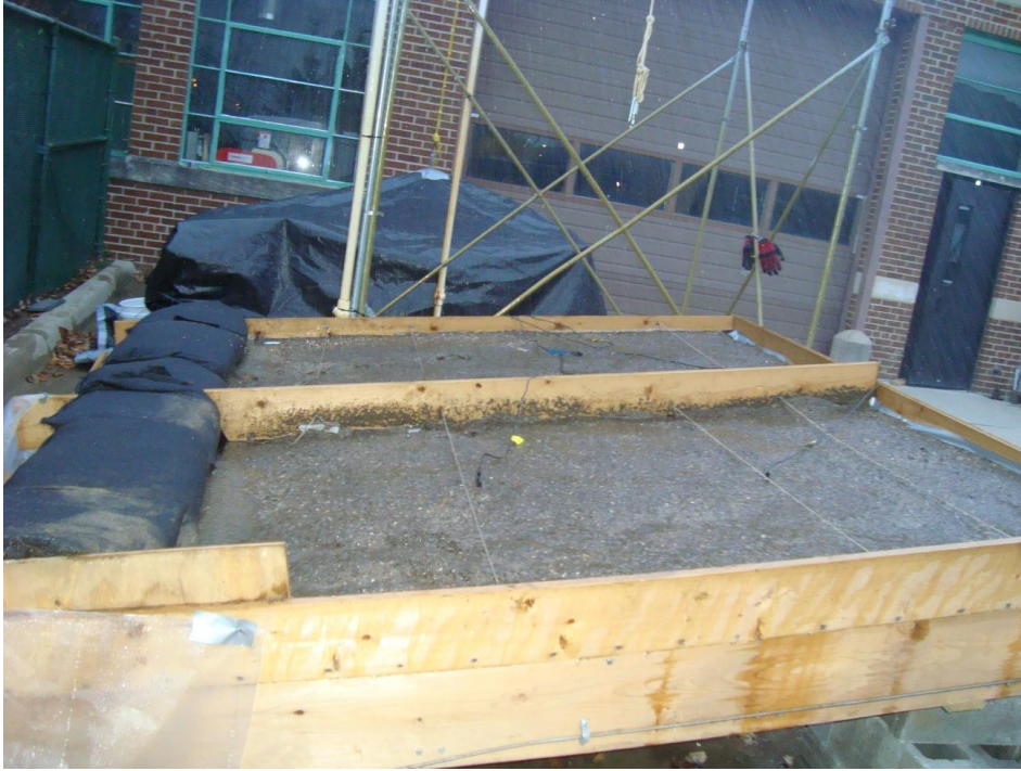
Ilustración 0-4 Prueba: Tratamiento Compost+Arena, 15%, Suelo Suelto
