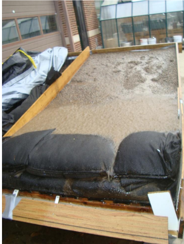
Ilustración 0-9 Prueba: Tratamiento Compost+Arena, 15%, Suelo Compacto
