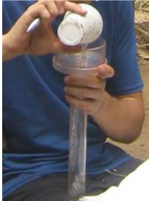
Figura 6.4 Medición de lámina de agua con pluviómetro. Fuente: El Autor
