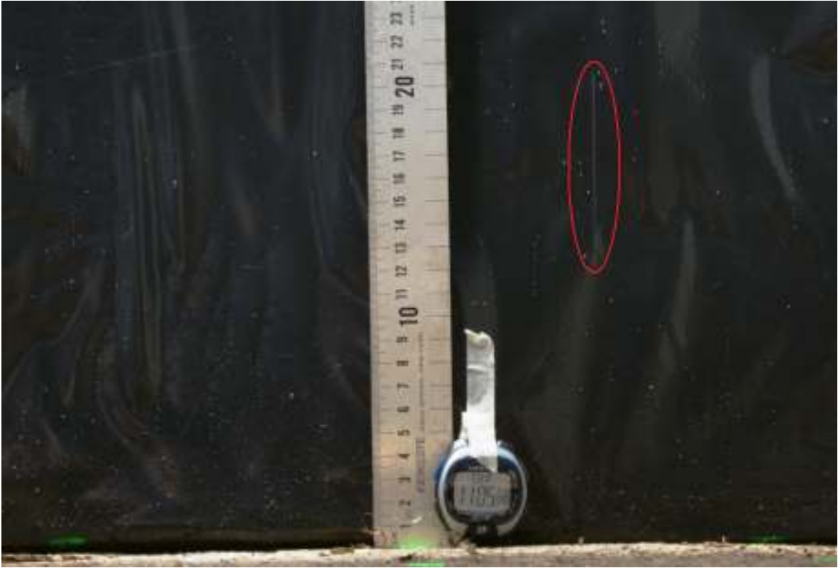
Figura 6.1 Obtención de línea generada por la caída de gota para el simulador de lluvia. Fuente: El Autor
