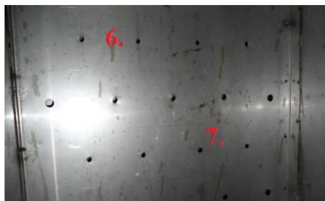
Figura 5.36 Distribución del flujo de aire (6) dentro del túnel de secado (7)
