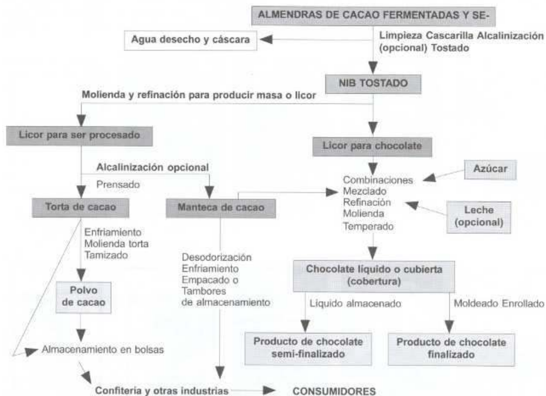
Figura 3.1 Etapas del proceso para la obtención del chocolate y sus subproductos (Fuente: Organismo Internacional del Cacao)
