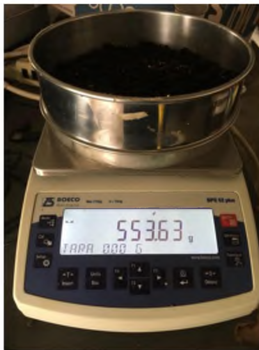
Figura 2.6 Registro de pérdida de agua en proceso de secado.
